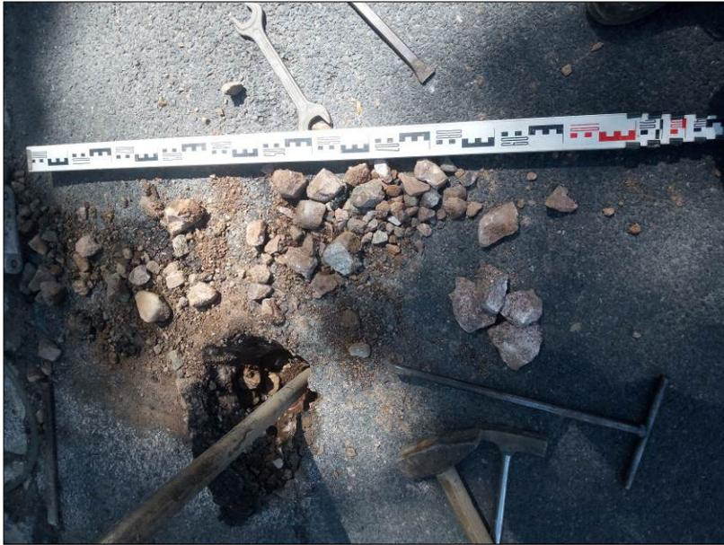
**Bild 6:** Grobstückige Auffüllung und Pflastersteine im Bereich der RKS 7/24, Foto: GIAB 09.07.2024
