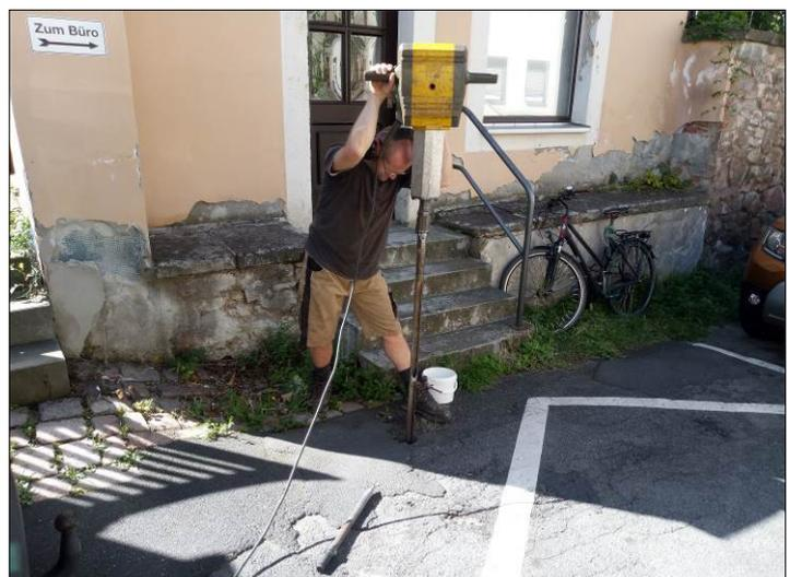
**Bild 2:** Abteufen der RKS 2/24 im Bereich der Zscheilaer Straße 8, Foto: GIAB 09.07.2024
