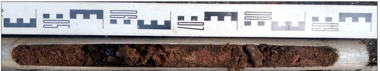
**Bild 8:** Sondeninhalt der RKS 4/24 mit künstlicher Auffüllung (0,50 m - 1,00 m), Foto: GIAB 09.07.2024
