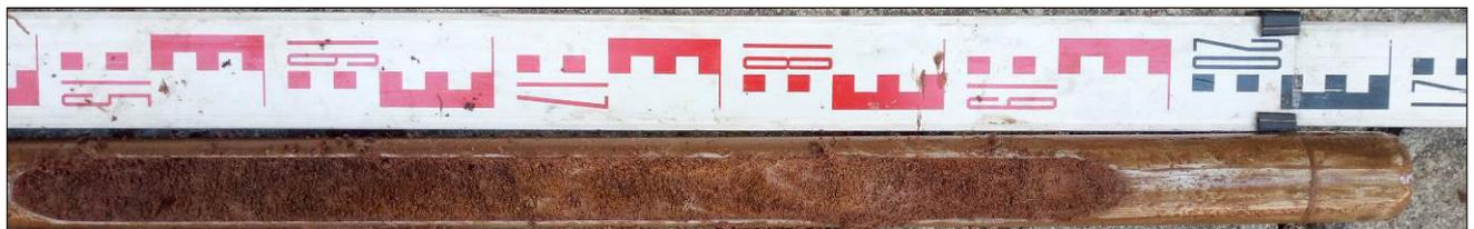
**Bild 10:** Sondeninhalt der RKS 4/24 mit dem Felsersatz des Syenits und dem Übergang zum verwitterten
