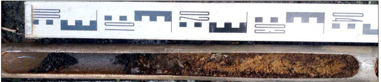
**Bild 7:** Sondeninhalt der RKS 4/24 mit Asphalt und künstlicher Auffüllung (0,00 m - 0,50 m)
