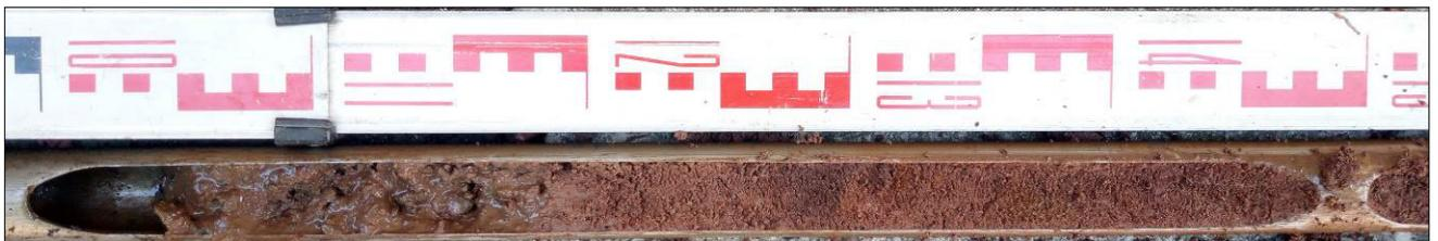
**Bild 9:** Sondeninhalt der RKS 4/24 mit künstlicher Auffüllung und Felsersatz des Syenits (1,00 m - 1,50 m),
