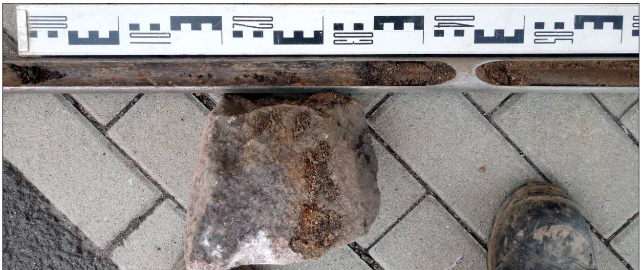
Bild 5: Sondeninhalt der RKS 1/24 mit Granitpflaster und künstlicher Auffüllung (0,00 m - 0,50 m) Foto: GIAB 10.07.2024
