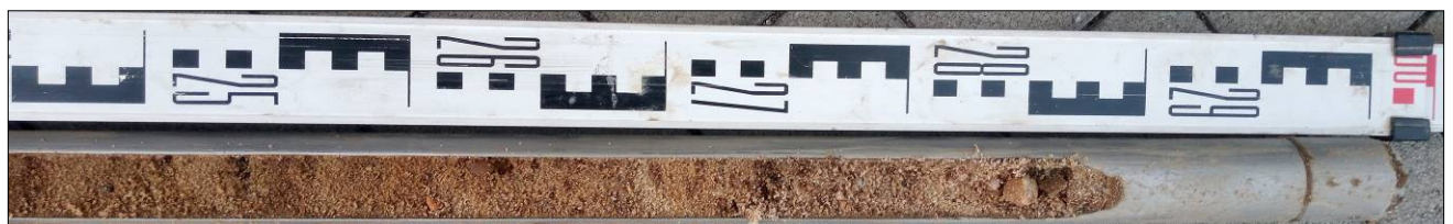
Bild 10: Sondeninhalt der RKS 1/24 mit Flusssanden und Übergang in Flusskiese der Elbe (2,50 m - 3,00 m), Foto: GIAB 10.07.2024
