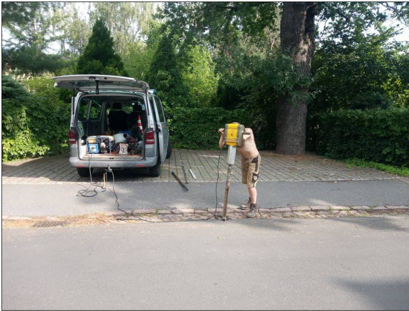
Bild 3: Abteufen der RKS 6/24 im Bereich Zscheilaer Straße 69 Foto: GIAB 10.07.2024
