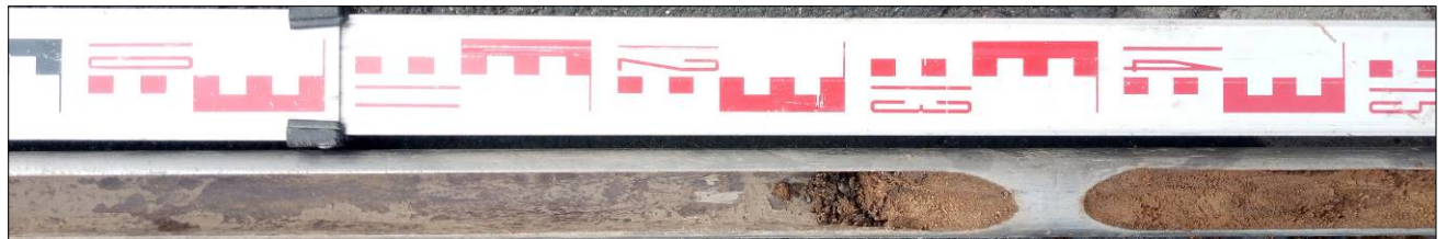
Bild 7: Sondeninhalt der RKS 1/24 mit künstlicher Auffüllung und Übergang in die Flusssande der Elbe (1,00 m - 1,50 m), Foto: GIAB 10.07.2024
