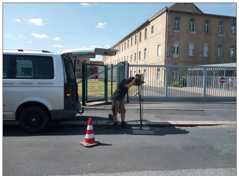
Bild 1: Abteufen der RKS 1/24 im Bereich der Zscheilaer Straße 35, Foto: GIAB 10.07.2024
