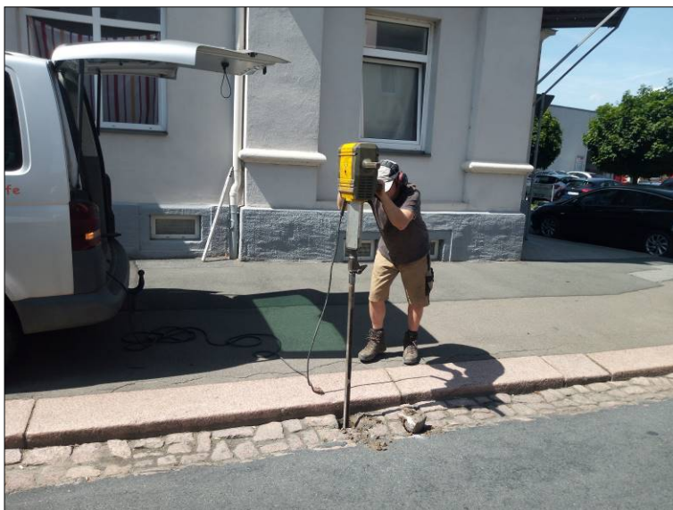
Bild 1: Abteufen der RKS 1/24 im Bereich der Zscheilaer Straße 35, Foto: GIAB 10.07.2024
