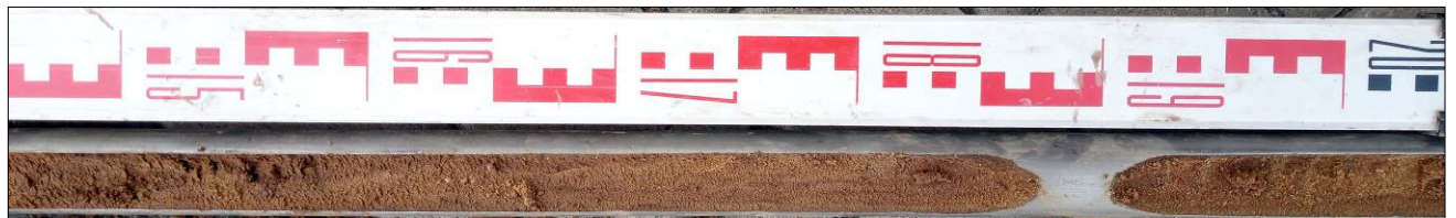
Bild 8: Sondeninhalt der RKS 1/24 mit Flusssanden der Elbe (1,50 m - 2,00 m), Foto: GIAB 10.07.2024
