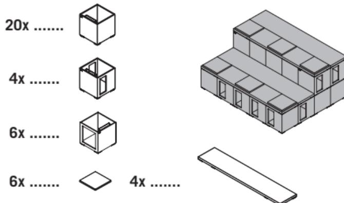
Ergänzende Elemente zur bestehenden Auflistung aus POS 2.05.50 und 2.05.60 zum Bau der Treppenanlage siehe Abbildung.
