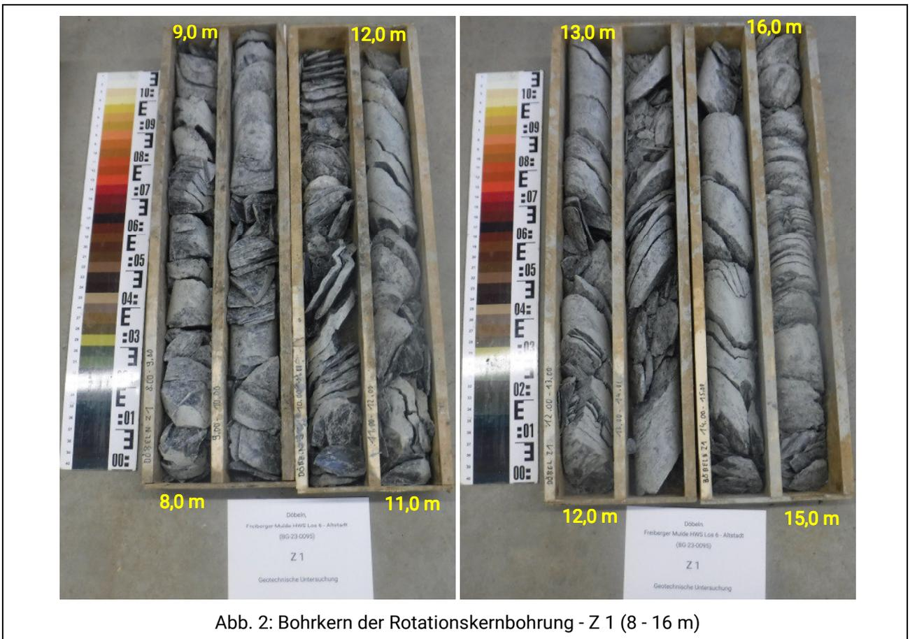
Abb. 2: Bohrkern der Rotationskernbohrung - Z 1 (8 - 16 m)
