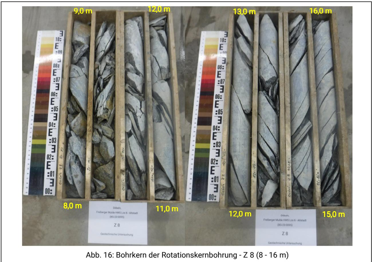
Abb. 16: Bohrkern der Rotationskernbohrung - Z 8 (8 - 16 m)
