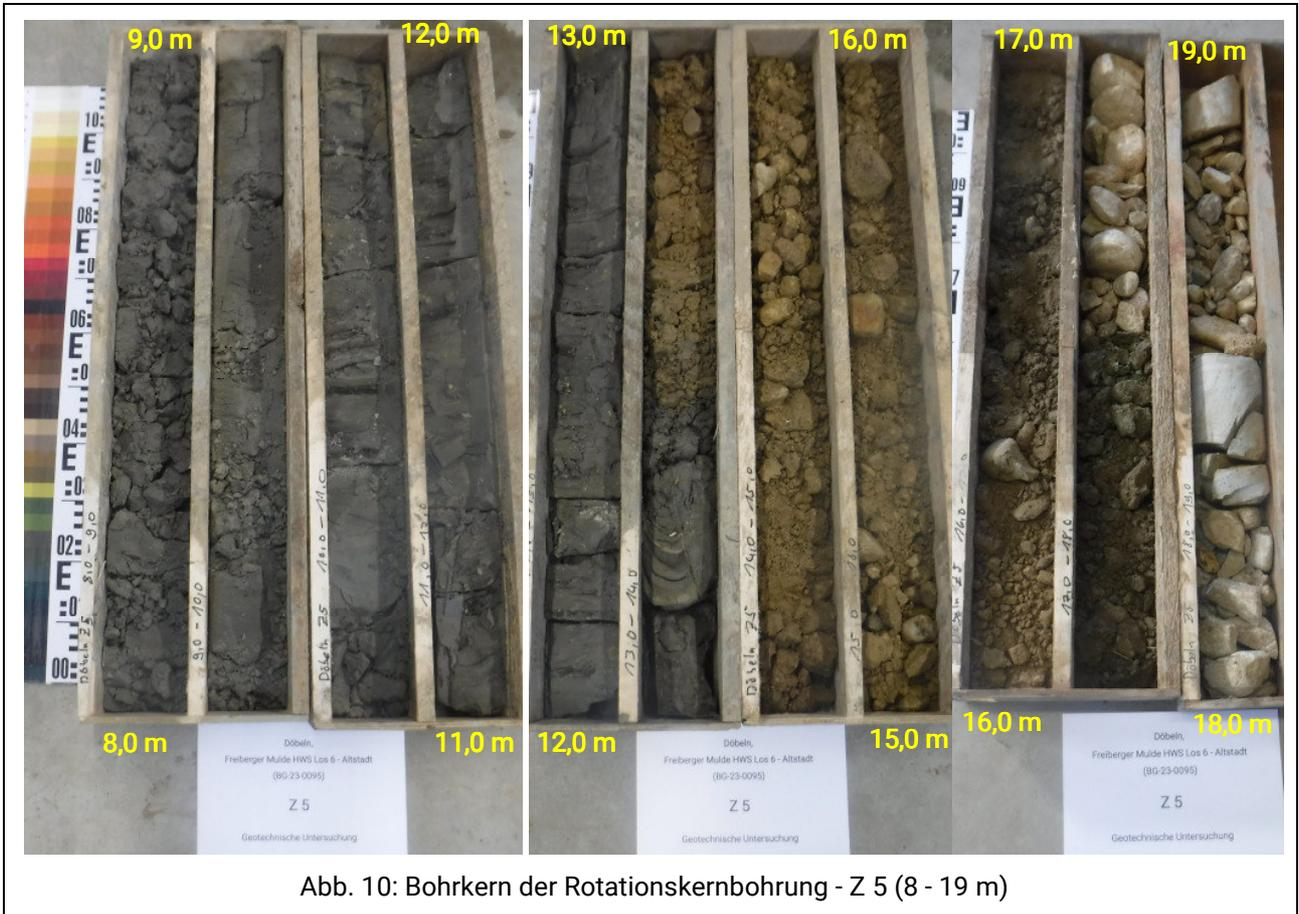
Abb. 10: Bohrkern der Rotationskernbohrung - Z 5 (8 - 19 m)
