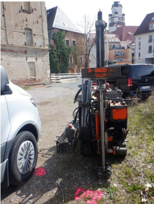
Abb. 15: Durchführung – DPH 2 bei Z 8
