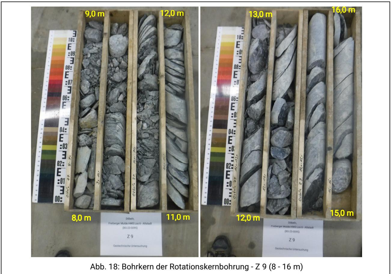
Abb. 18: Bohrkern der Rotationskernbohrung - Z 9 (8 - 16 m)
