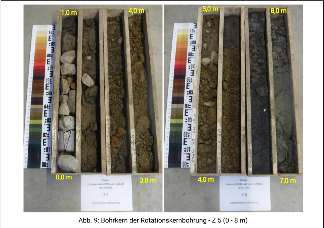
Abb. 9: Bohrkern der Rotationskernbohrung - Z 5 (0 - 8 m)
