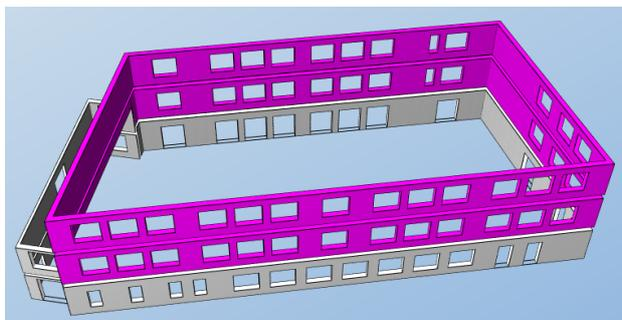
Abbildung 8: Übersicht Bauteile der thermischen Hülle, Außenwand Putz, Isometrie
