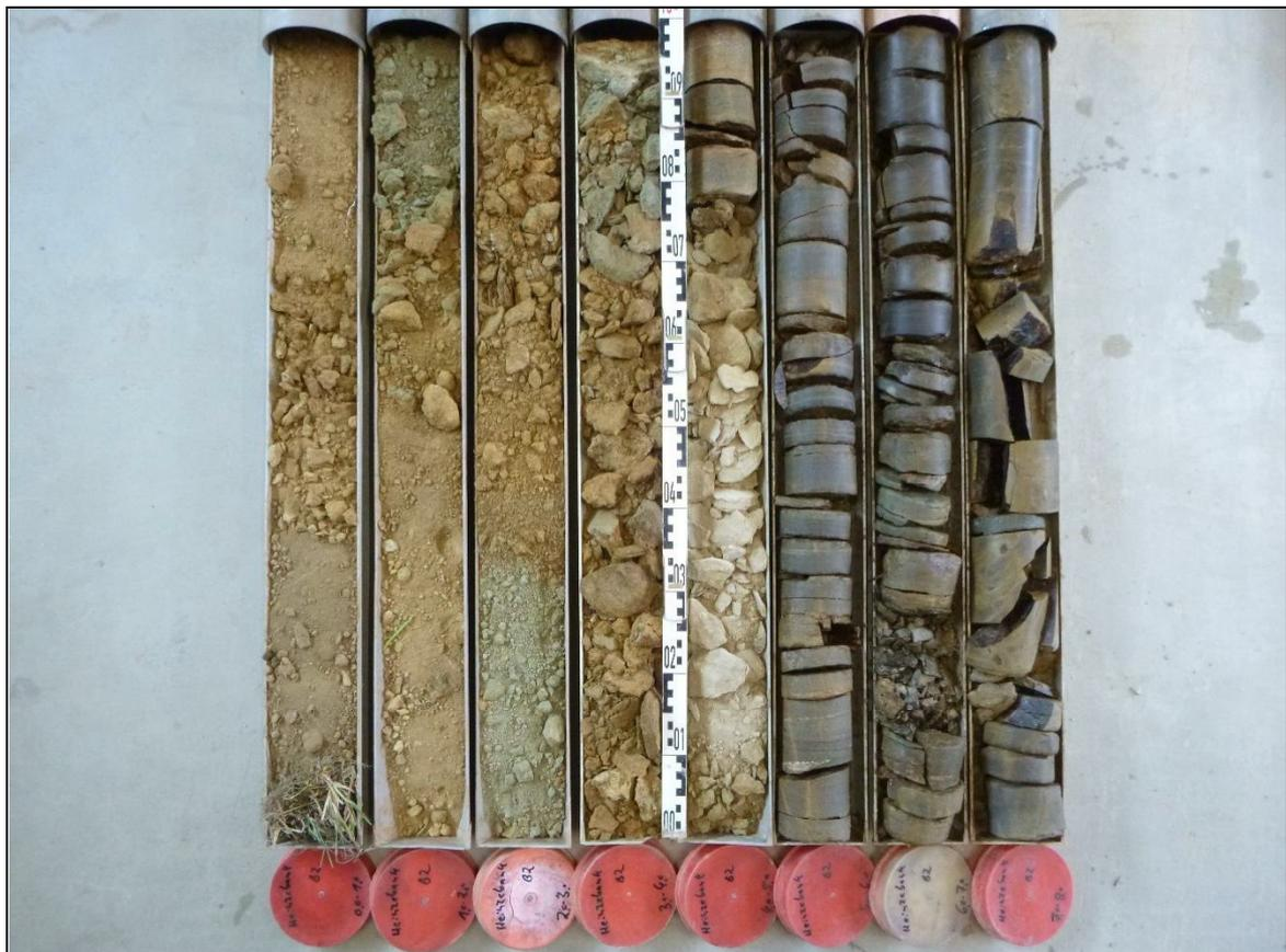
**Rotationskernbohrung (KB) 2 – Ansicht Bohrkern**
