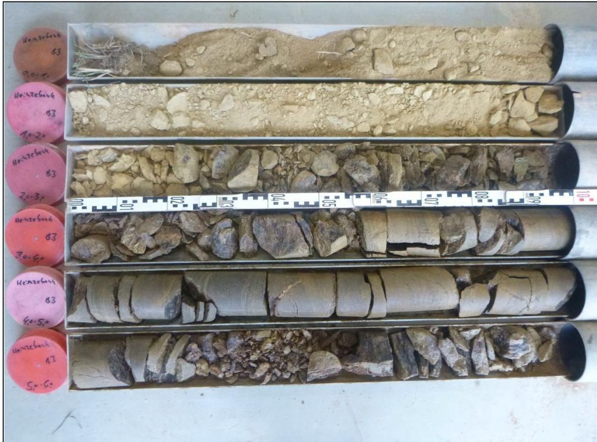
**Rotationskernbohrung (KB) 3 – Ansicht Bohrkern**
