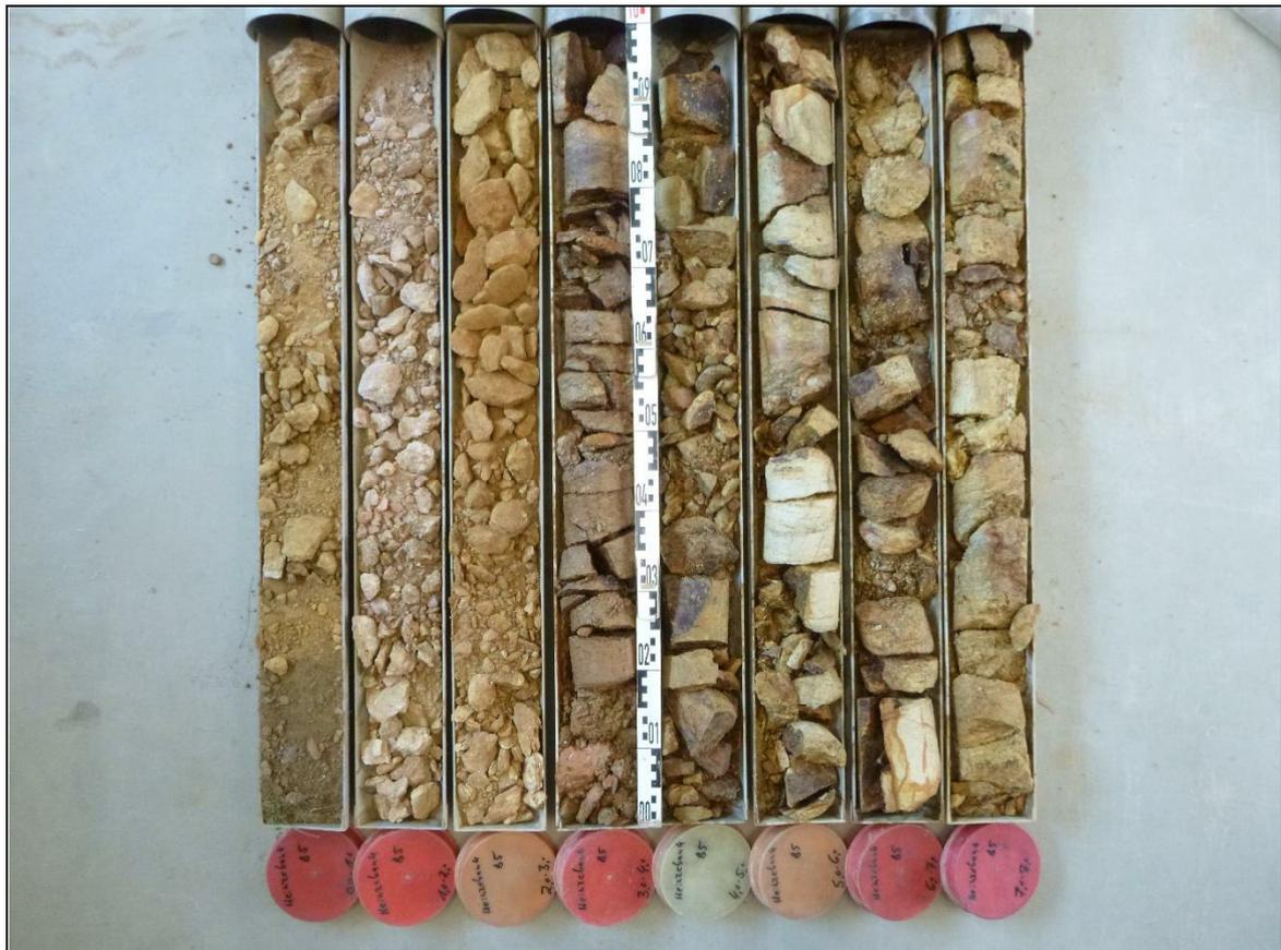
**Rotationskernbohrung (KB) 5 – Ansicht Bohrkern**
