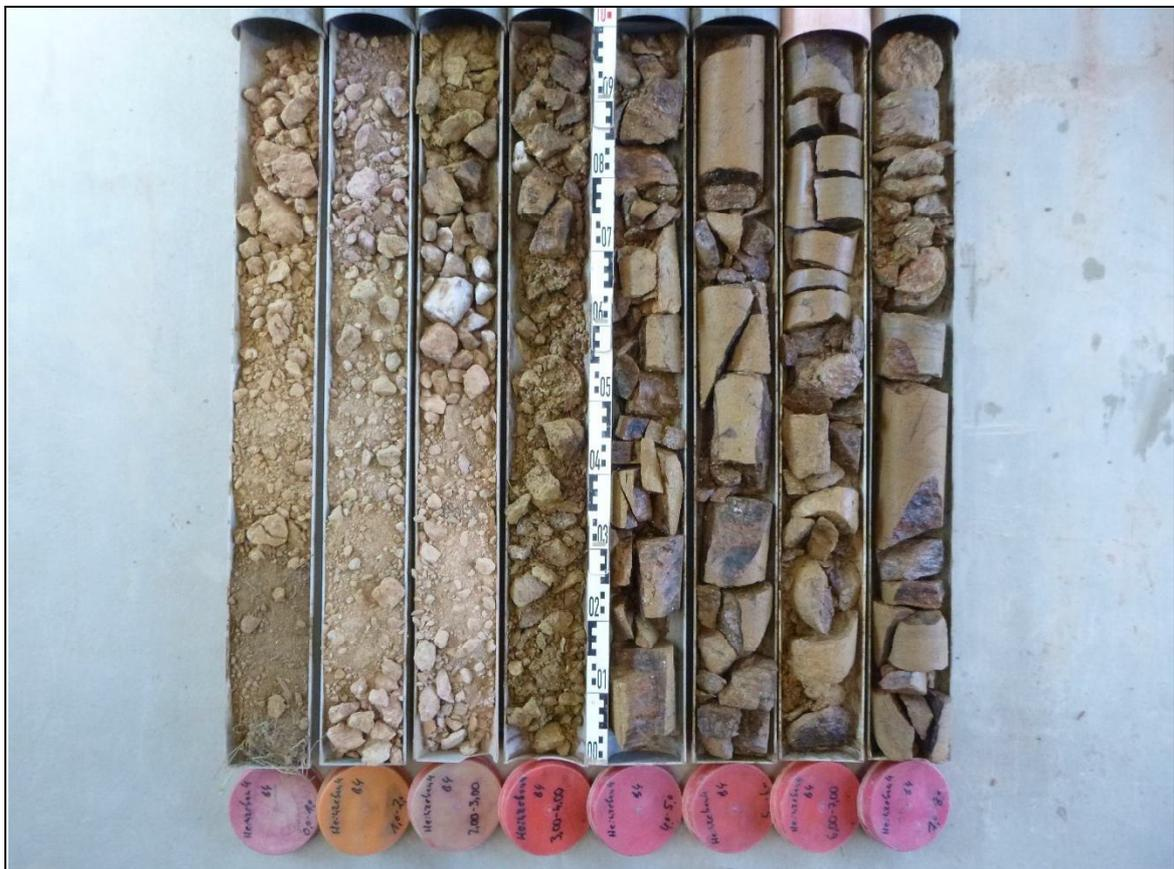
**Rotationskernbohrung (KB) 4 – Ansicht Bohrkern**
