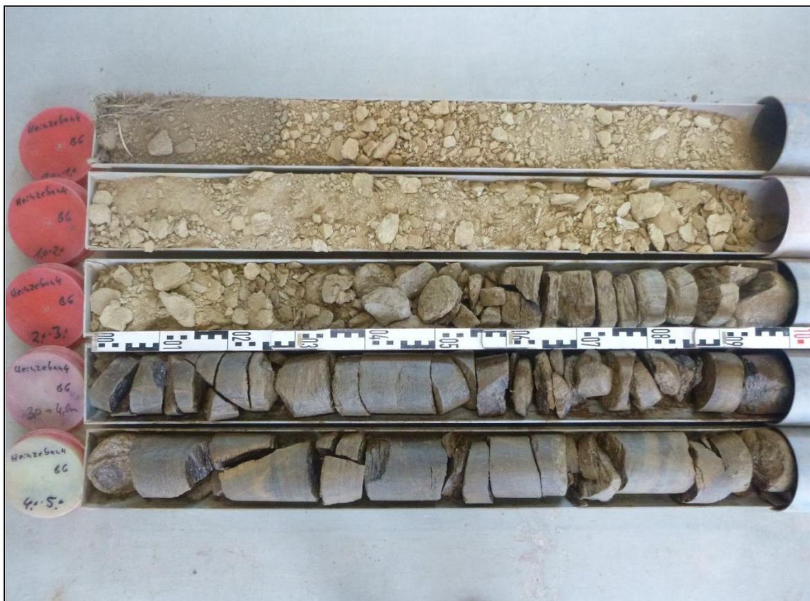
Rotationskernbohrung (KB) 6 – Ansicht Bohrkern
