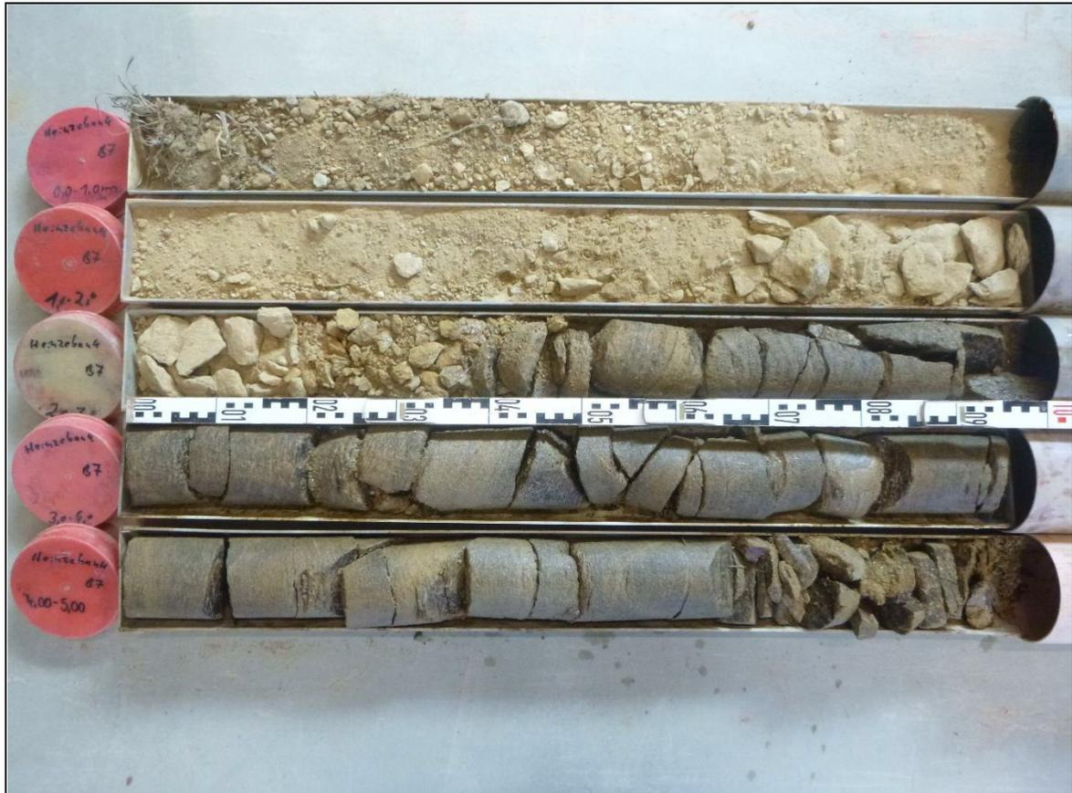
**Rotationskernbohrung (KB) 7 – Ansicht Bohrkern**
