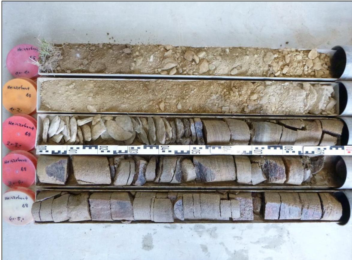
**Rotationskernbohrung (KB) 8 – Ansicht Bohrkern**
