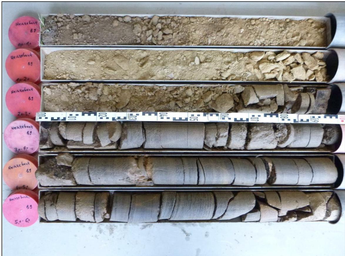
**Rotationskernbohrung (KB) 9 – Ansicht Bohrkern**
