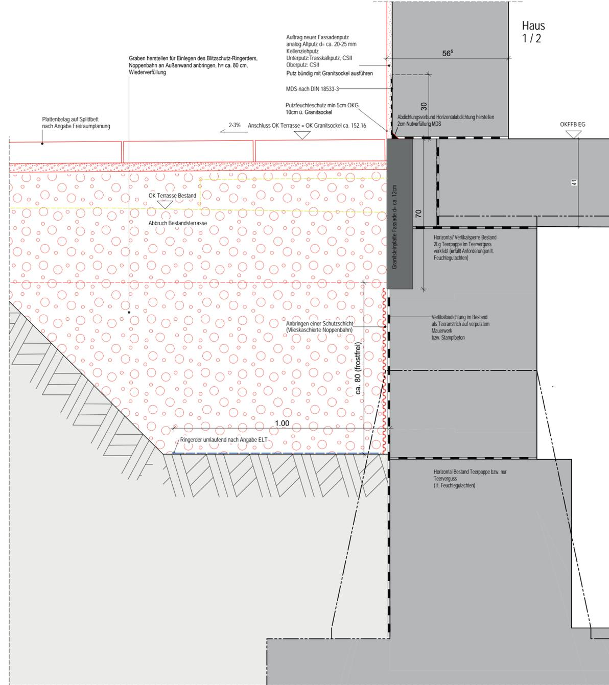
Vertikalschnitt Abdichtung Außenwand / Sockelputz Bereich Terrasse Altbau H1/H2 - M1:10
