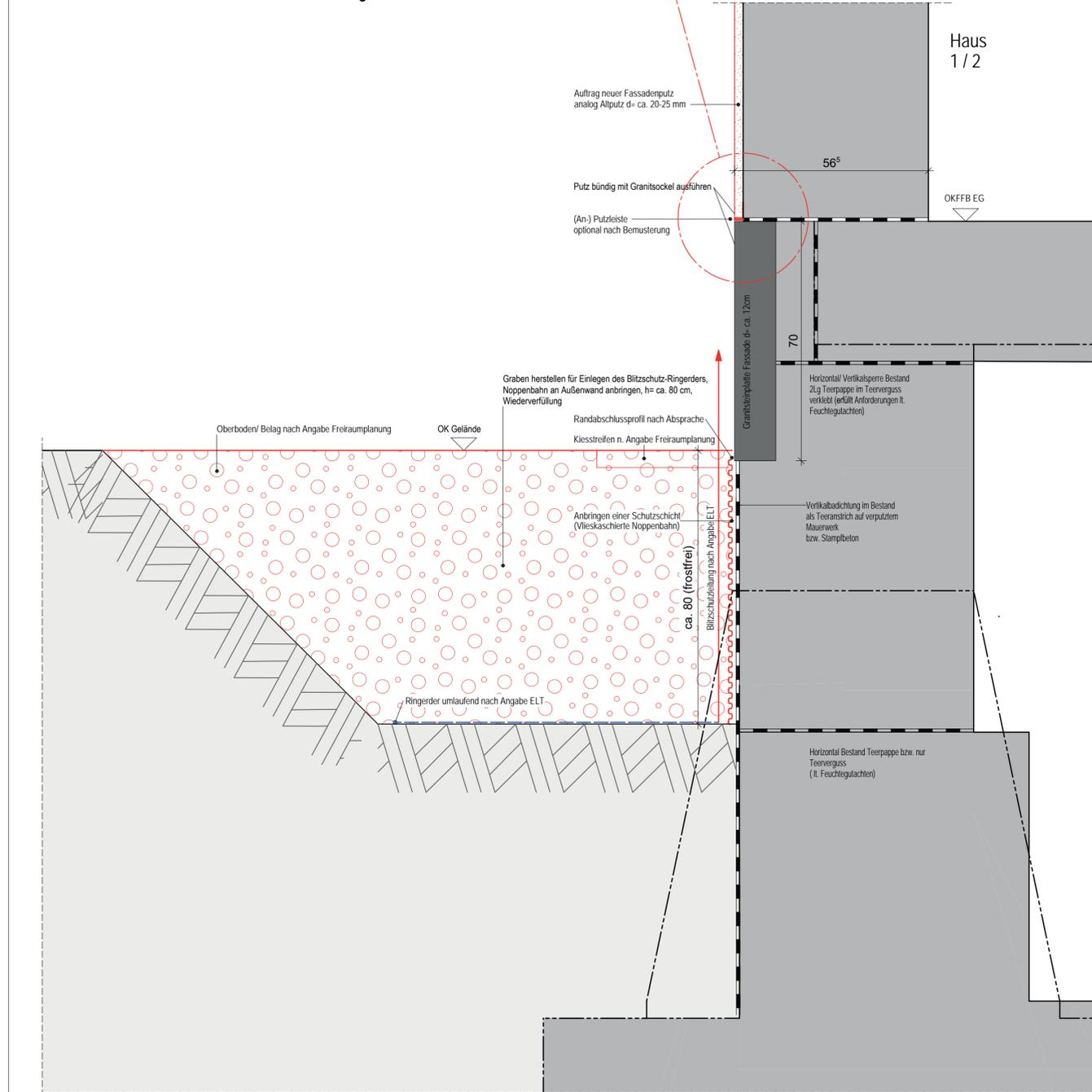
Vertikalschnitt Abdichtung Außenwand Altbau H1/2 - M 1:10
