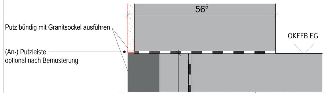
Vertikalschnitt Außenwand Altbau H1/2 - Fuge zwischen Granitsockel und Putz - M1:5
