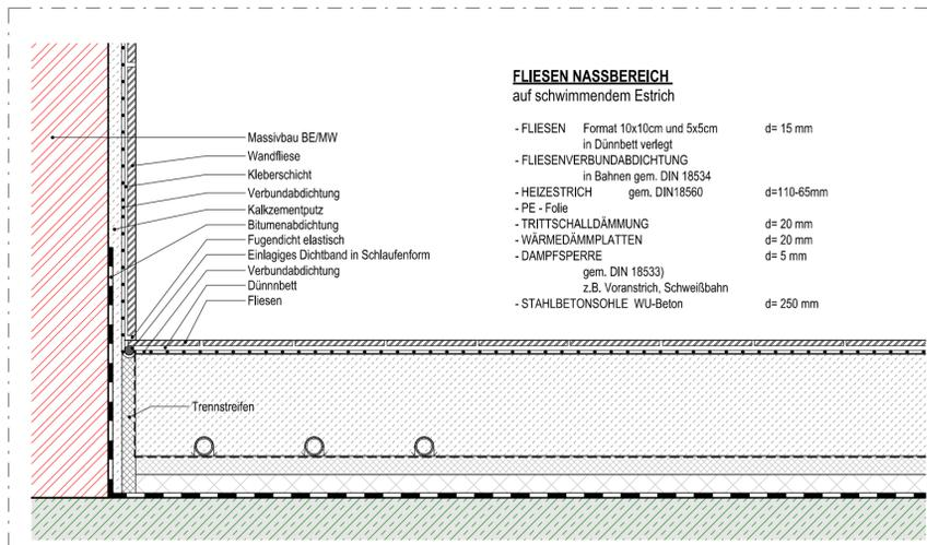
**DT SU 408.1b - Bodenanschluss Massivbau**
