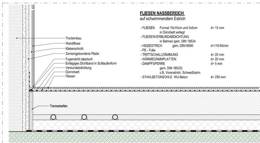
**DT SU 408.1a - Bodenanschluss Trockenbau**
