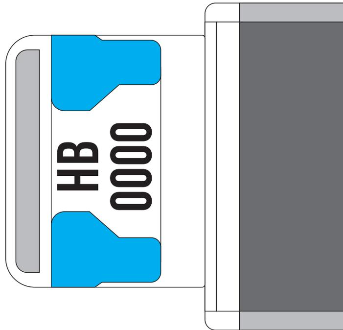
Die Fahrzeuge erhalten eine Dachkennzeichnung nach **DIN 14502-3**.
