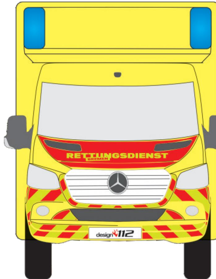
Die Motorhaube wird zu **mindestens zwei Dritteln** rot foliert. Auf dem folierten Bereich steht in retroreflektierendem Gelb der Hauptschriftzug.
