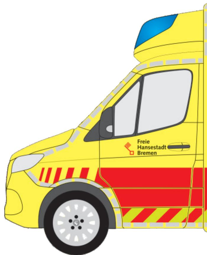
Die Konturmarkierung erfolgt bei Großfahrzeugen und Fahrzeugen der Transporter-Klasse seitlich und am Heck in Form von umlaufenden **Maxi-Gaps**, PKW erhalten seitlich eine zweireihige Linienmarkierung in **Gap-Form** bei der die A-Säule mit markiert wird.
