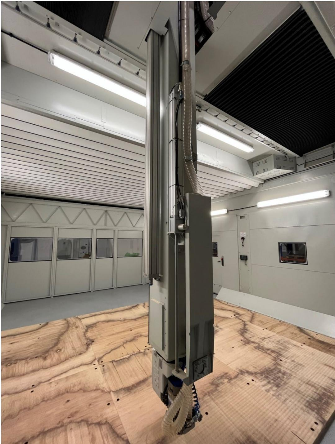
Abb.1: Fräsachse mit vorgesetztem Linearschlitten (1000mm Hub) zur Integration eines Extruders
