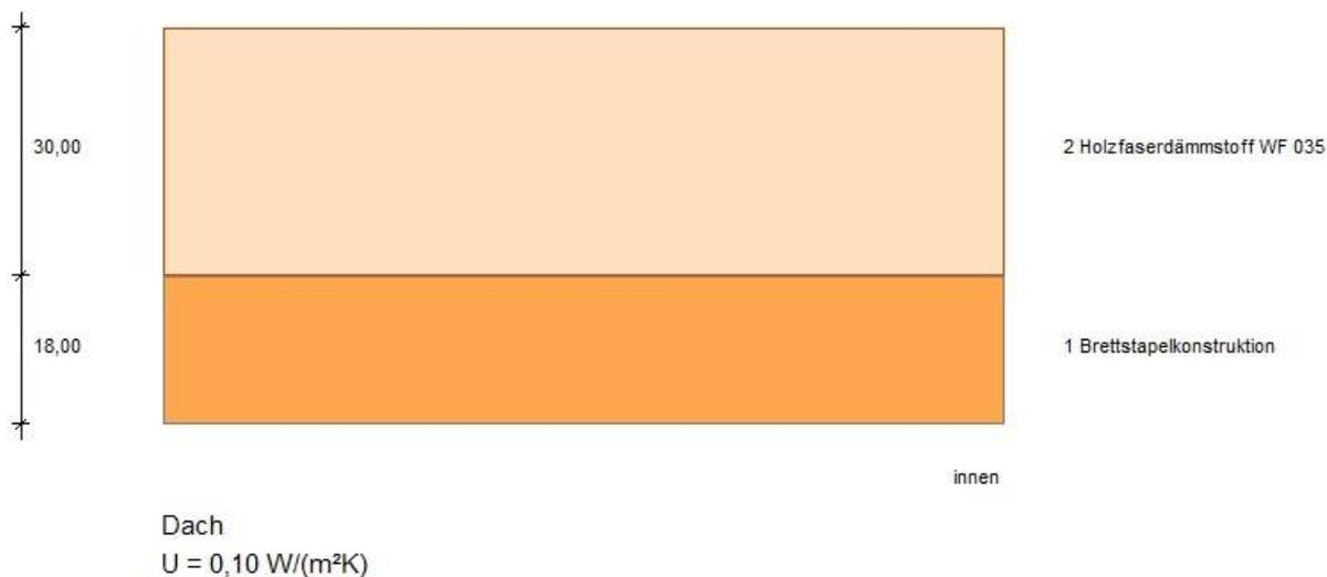
Bauteiltyp "Decke gegen die Außenluft"
