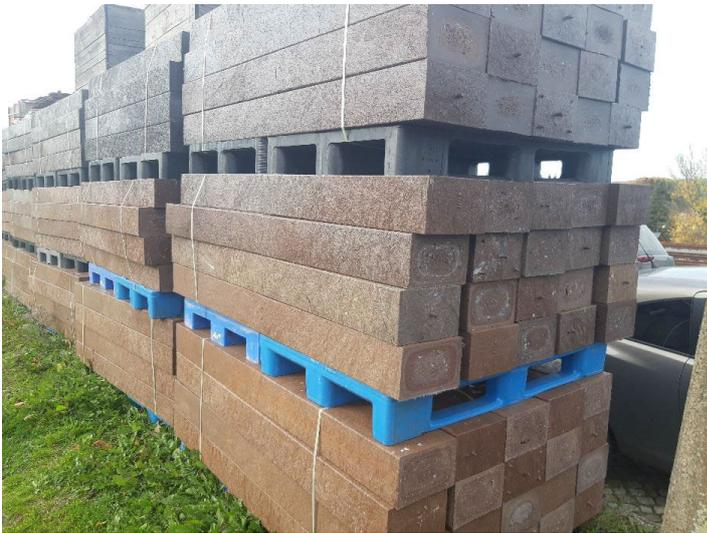
Abbildung 3: Beispiel Recyclingschwelle Spur 600mm
