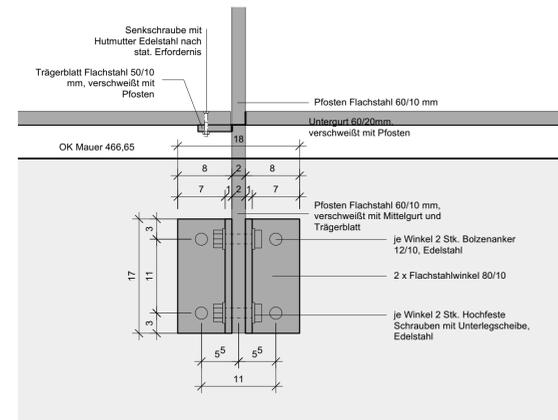
**Detail C Pfostenbefestigung: Aufsicht M 1:5**
