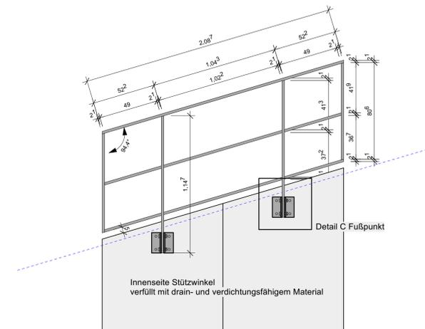
**Detail C Pfostenbefestigung: Ansicht M 1:5**
