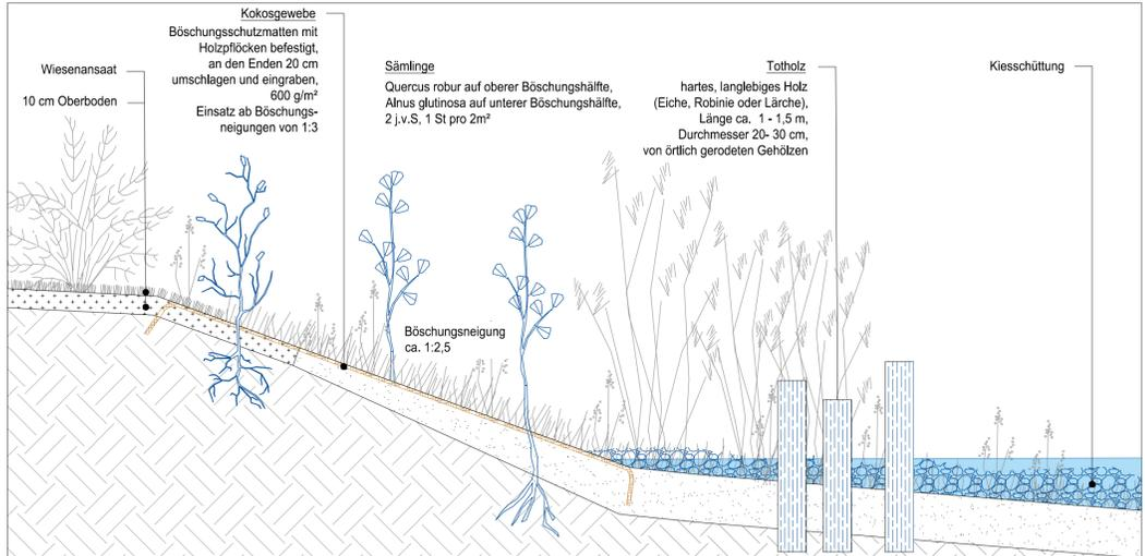
Regeldetail 2: Sämlinge, Totholz, Kiesschüttung und Böschungssicherung Kokosgewebe, M 1:20
