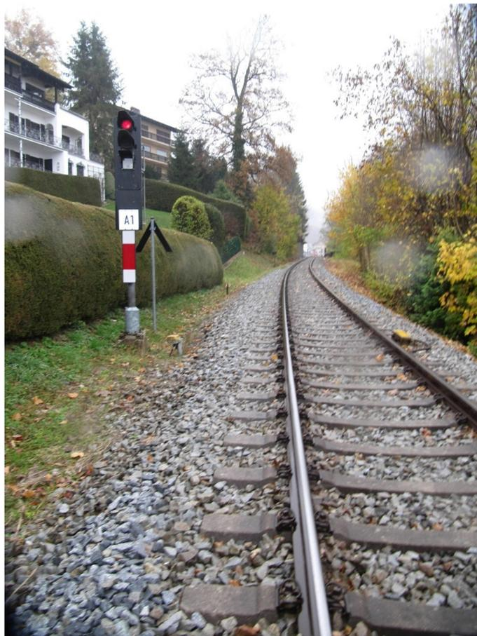
Abb. 104 Einfahrsignal A1 (km 11,888)
