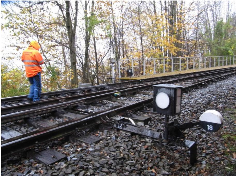
**Abb. 105 Elektrische Weiche 12 mit Ortsbedieneinrichtung (km 12,06)**
