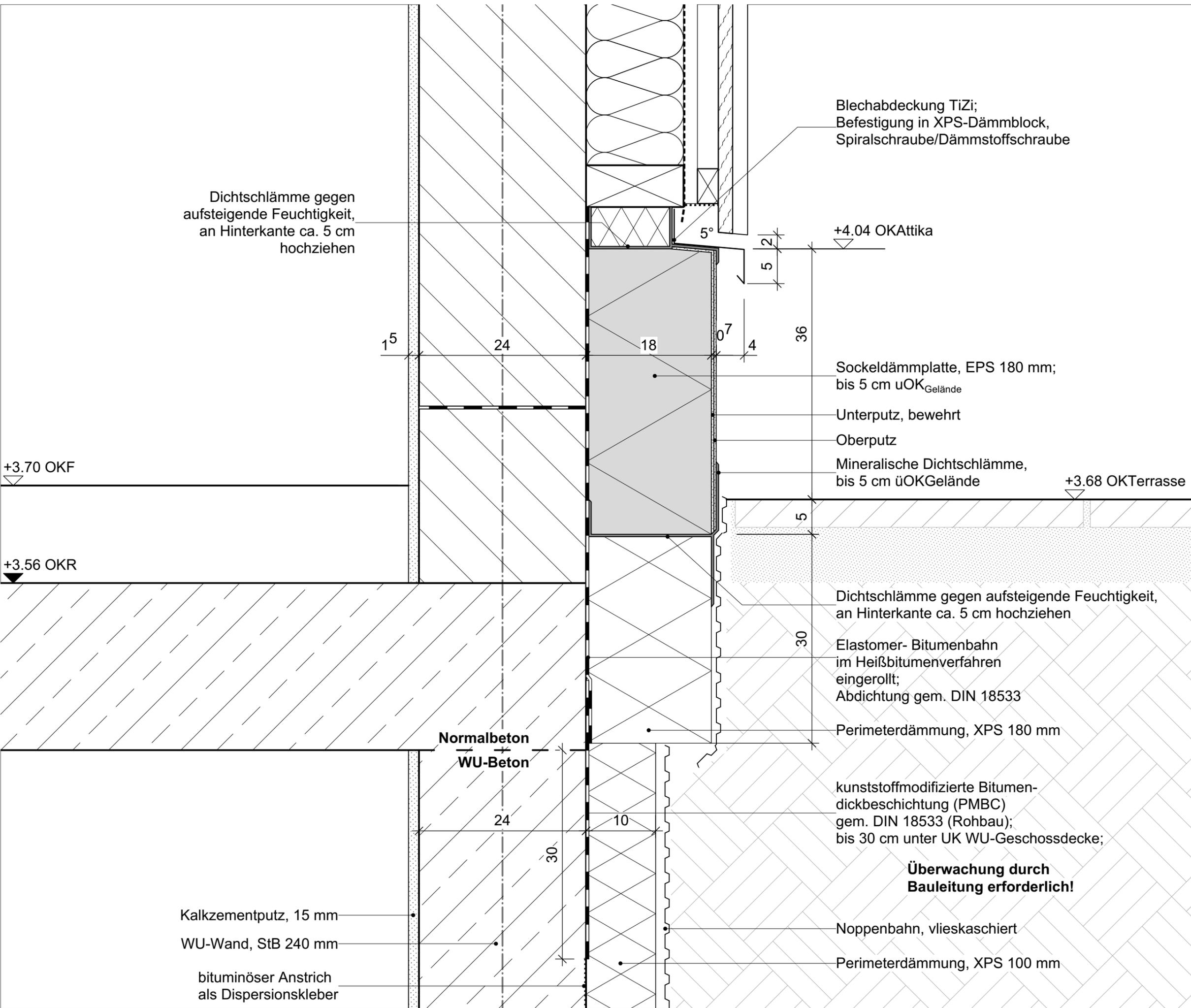
Dichtschlämme gegen aufsteigende Feuchtigkeit, an Hinterkante ca. 5 cm hochziehen
