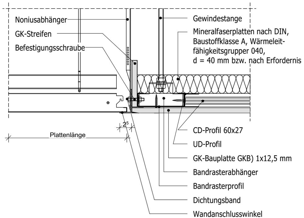
Detail Trockenbau Decke
