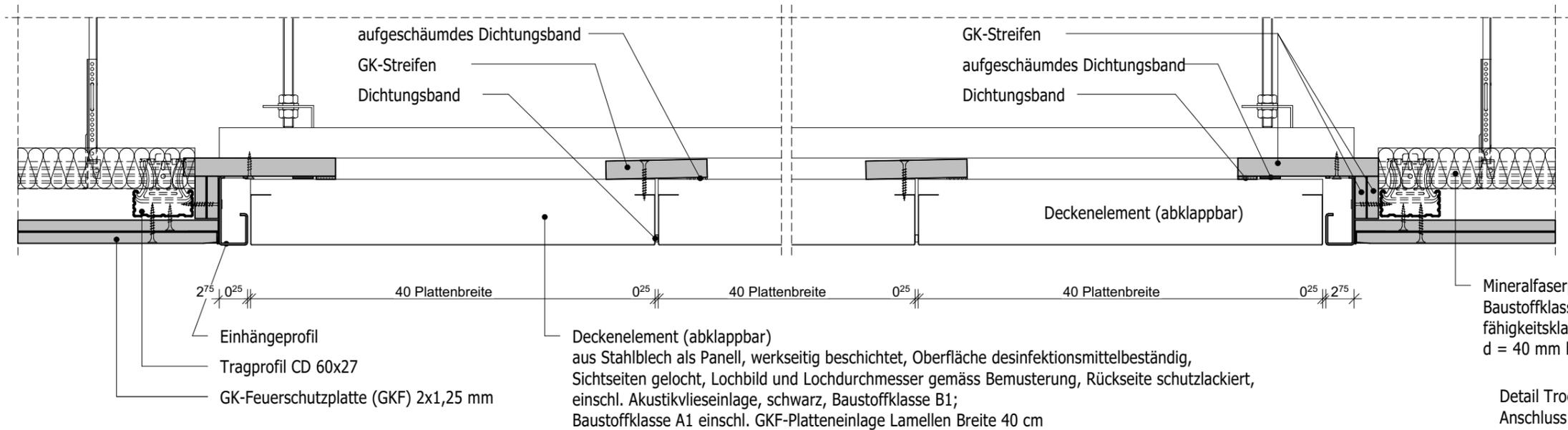
Detail Trockenbau Decke
