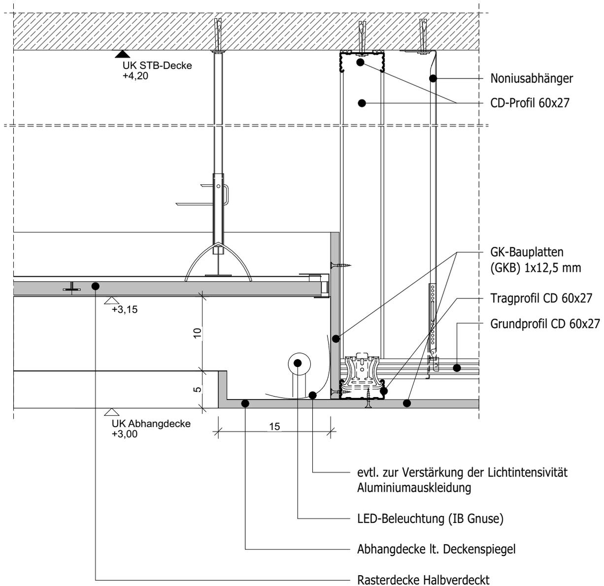
Detail Trockenbau Decke
