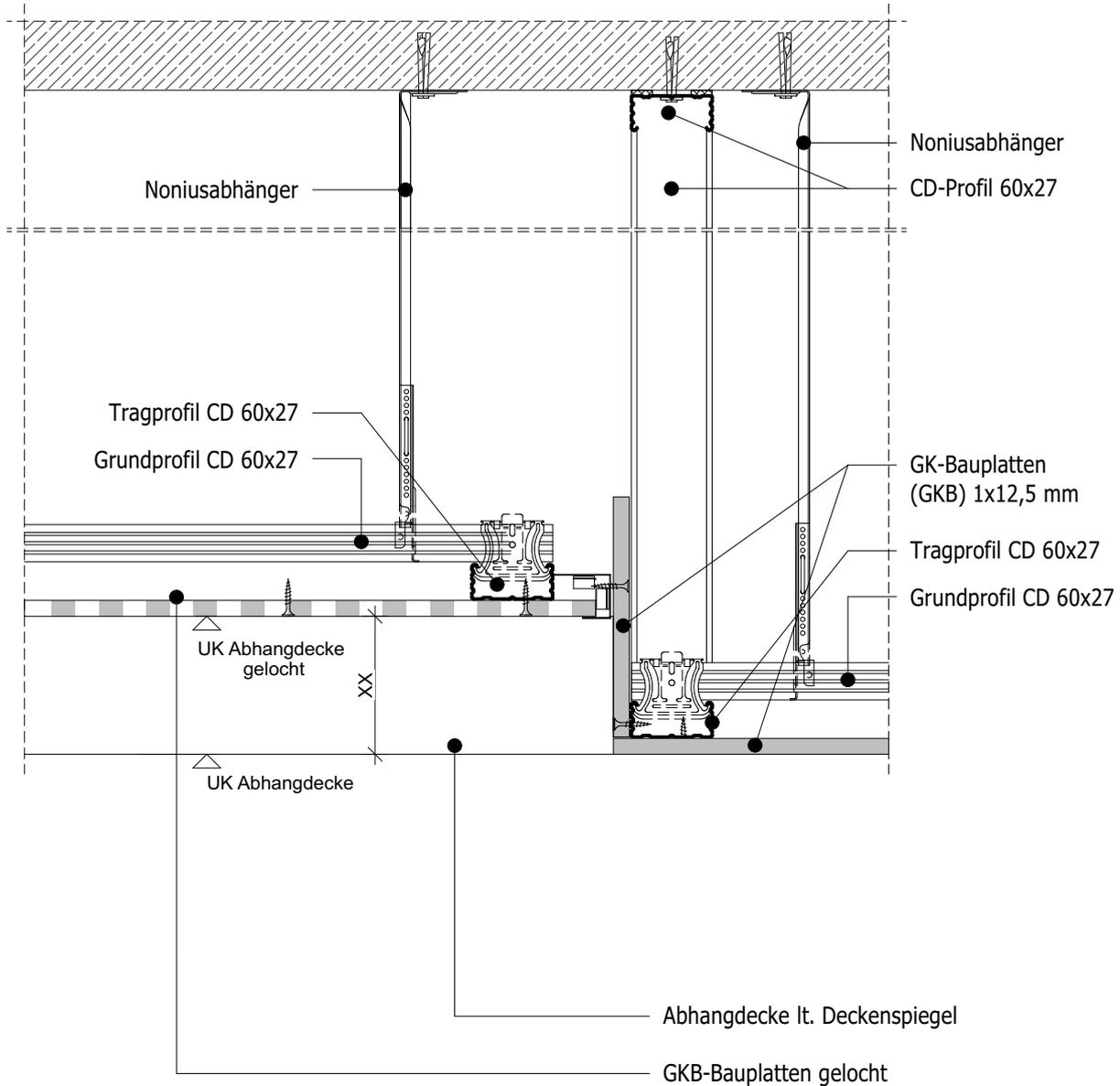
Detail Trockenbau Decke
