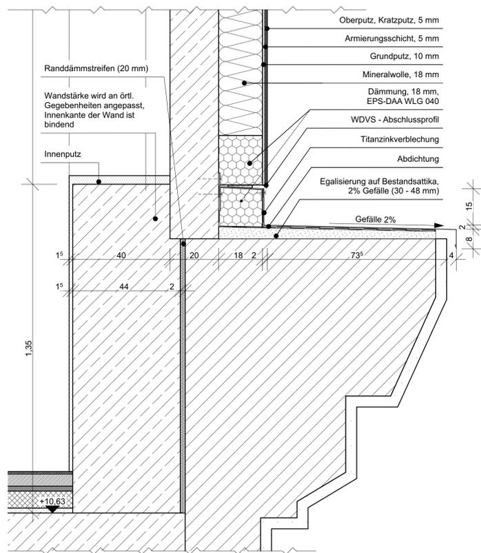
**ABDICHTUNG DACH K - SCHNITT C-C**
