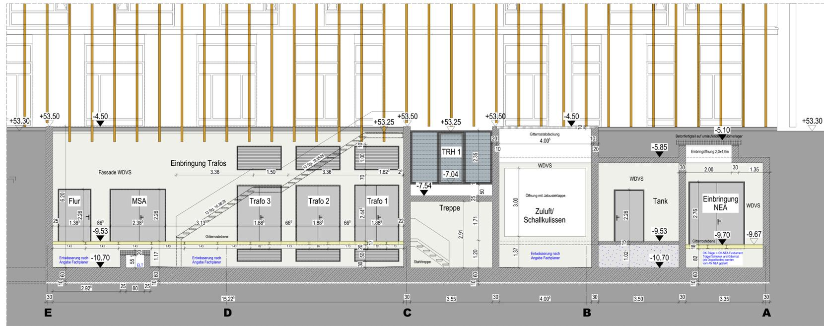
SC\_5 - Teilschnitt Außenbauwerk UG Achse 1/A-E
