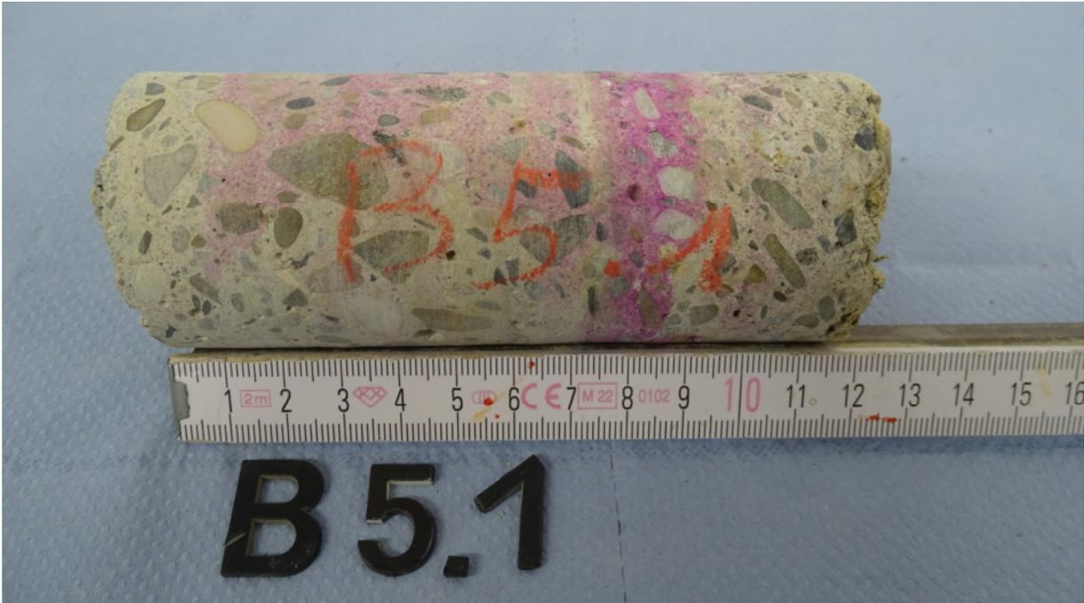
Bild 3: Betonbohrkern B5.1
