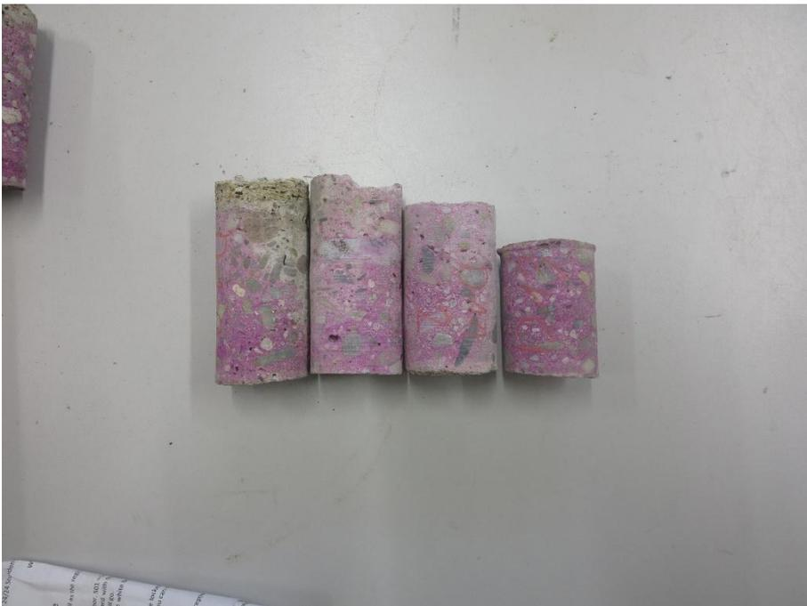
Abbildung 57: Zur Bestimmung der Karbonatisierungstiefe angefärbte Bohrkern von D 1/3/11/13 (links nach rechts).
