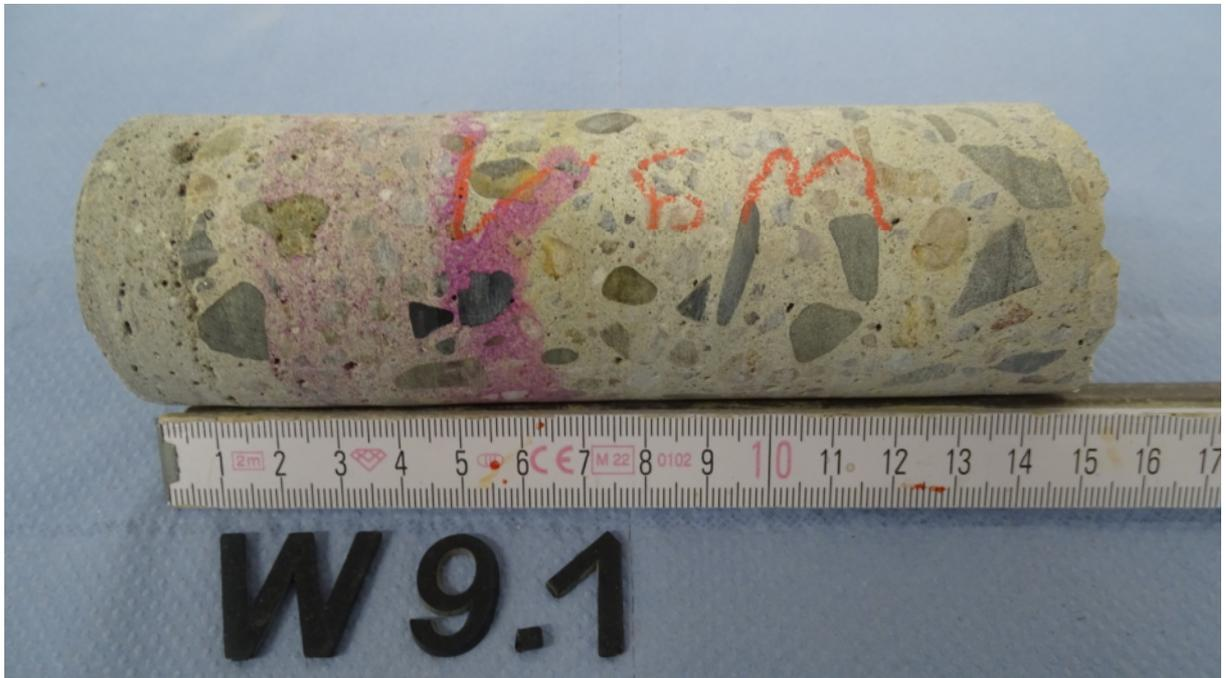
Bild 5: Betonbohrkern W9.1
