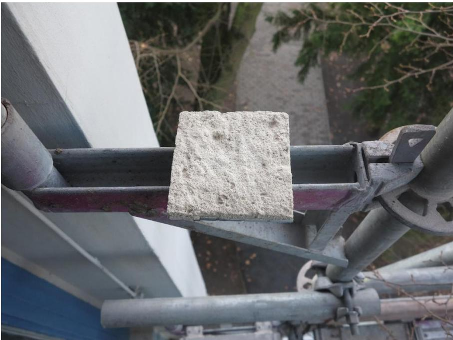
Abbildung 96: Rückseite der Probe. Der Unterputz weist hier eine porige Struktur auf.
