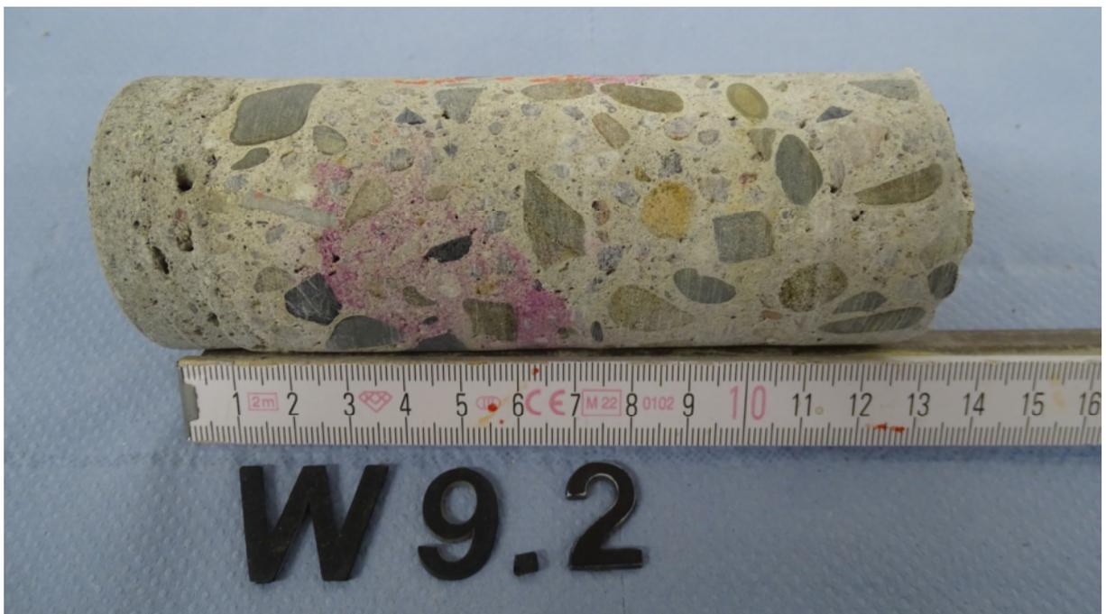
Bild 6: Betonbohrkern W9.2
