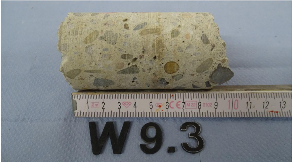
Bild 7: Betonbohrkern W9.3
