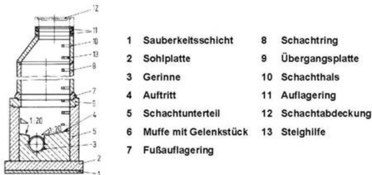
Abbildung 19 Schacht-Querschnittsskizze
