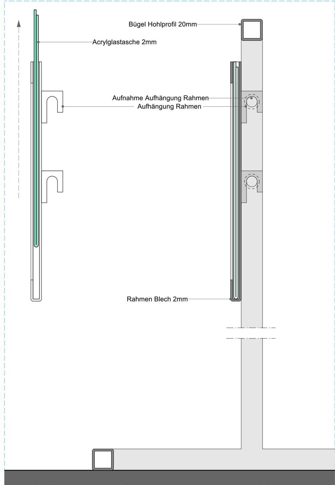
**Detail Vertikalschnitt A-A'**
