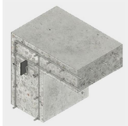
Auszug aus [10] zum Prinzip Arbeitsfuge Grubenwandkopf / Bodenplatte
