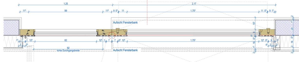
Horizontalschnitt Fenster Bereich Schwingflügel M 1:10
