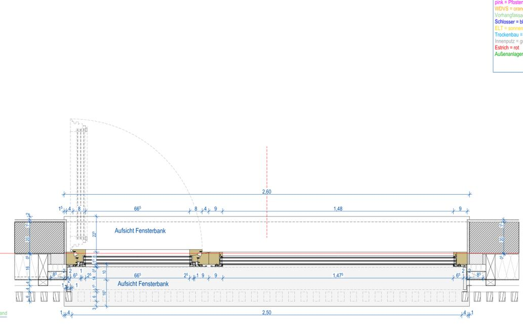
Horizontalschnitt Fenster mit Festverglasung Typ 4.1 M 1:10
