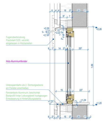
Vertikalschnitt Fenster Typ 4.2 Öffnungsflügel M 1:10
