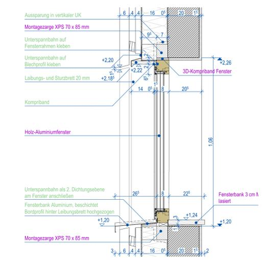
Vertikalschnitt Fenster Typ 4.1 Festverglasung M 1:10
