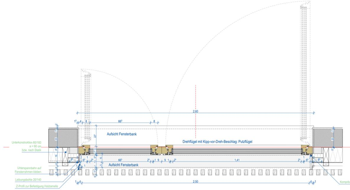
Horizontalschnitt Fenster mit Öffnungsflügel hinter Holzlamellenfassade Typ 4.2 M 1:10
