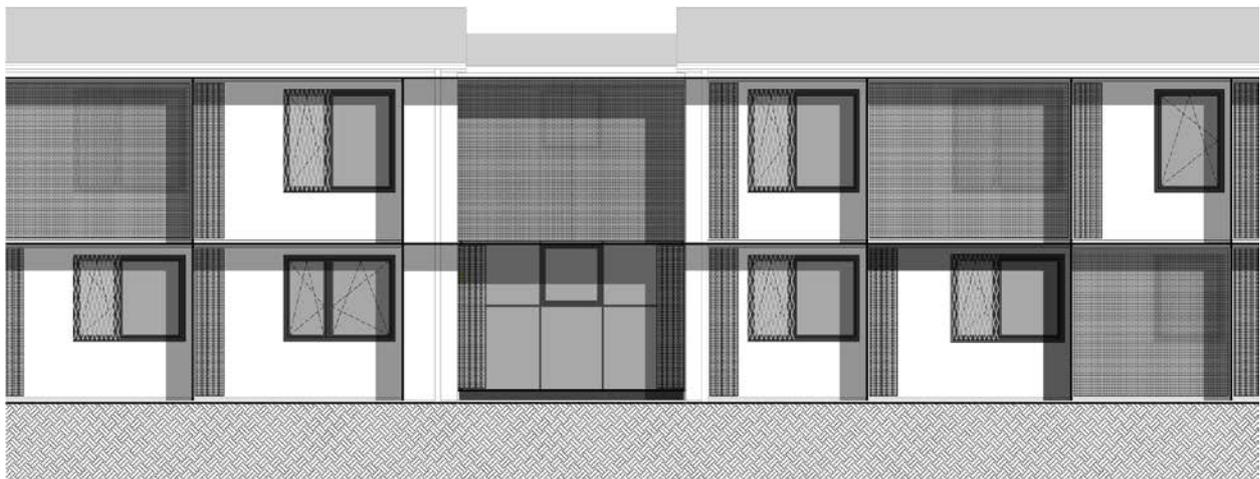
Variante Fenster mit Drahtgitterfüllung und vorgelagerter Fassade mit Vorhängen
