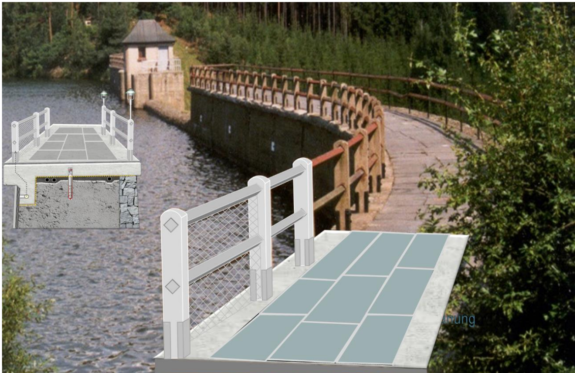
Abbildung 18: Skizze zur Instandsetzung der Mauerkrone, Sattelmauer
