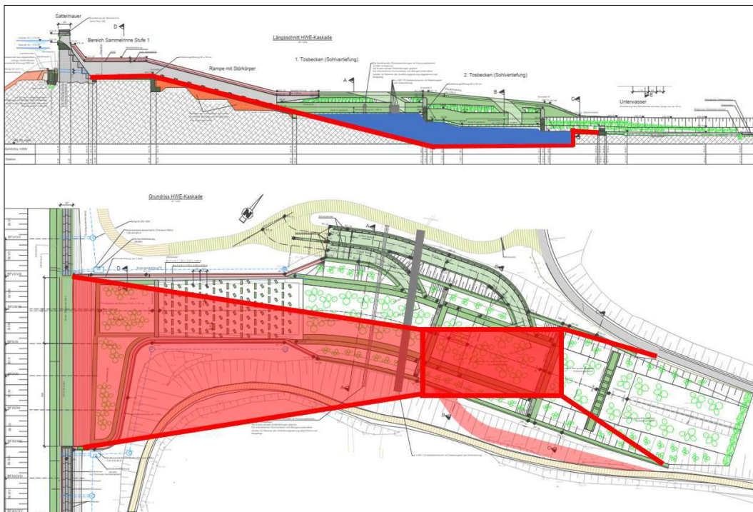
Abb. 10: HWE - Ausführung als gerade Schussrinne, Quelle, Abbildung 3-3 Value Management Studie [14]
