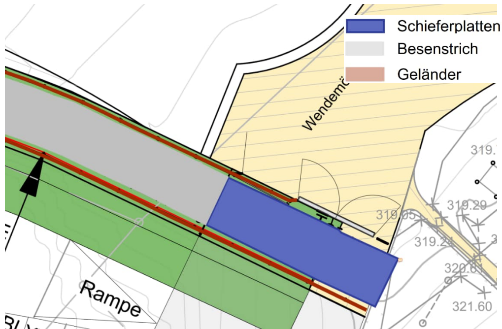
Abb. 3-1.: Schieferplatten rechte Seite Sattelmauer
