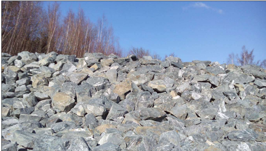
Abb. 5: Bruchsteine, Diabas im Steinbruch Lauterbach der Hartsteinwerke Vogtland GmbH & Co. KG
