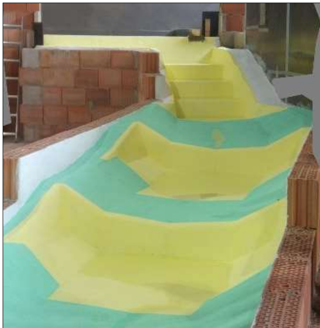
Abb. 7: Modell der HWE an der Sattelmauer im Ist-Zustand; Quelle, Abbildung 1 in [14]
