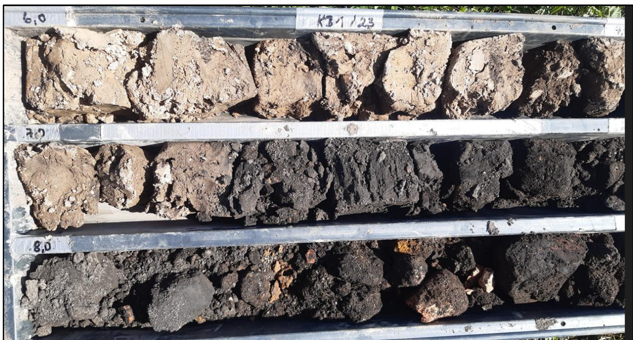
Abb. 6-2 Zusammensetzung der Auffüllung am Dammbauwerk Beispielhaft an KB1/23
