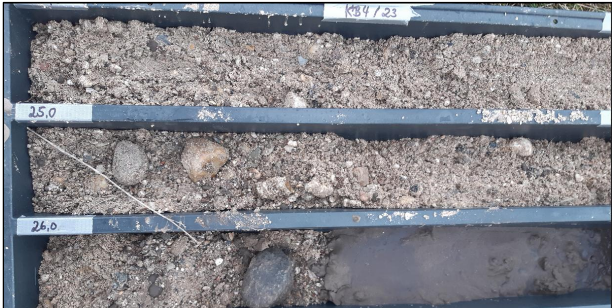
Abb. 6-6 Übergang Saalehauptterrasse/tertiäre Sande am Beispiel der KB4/23
