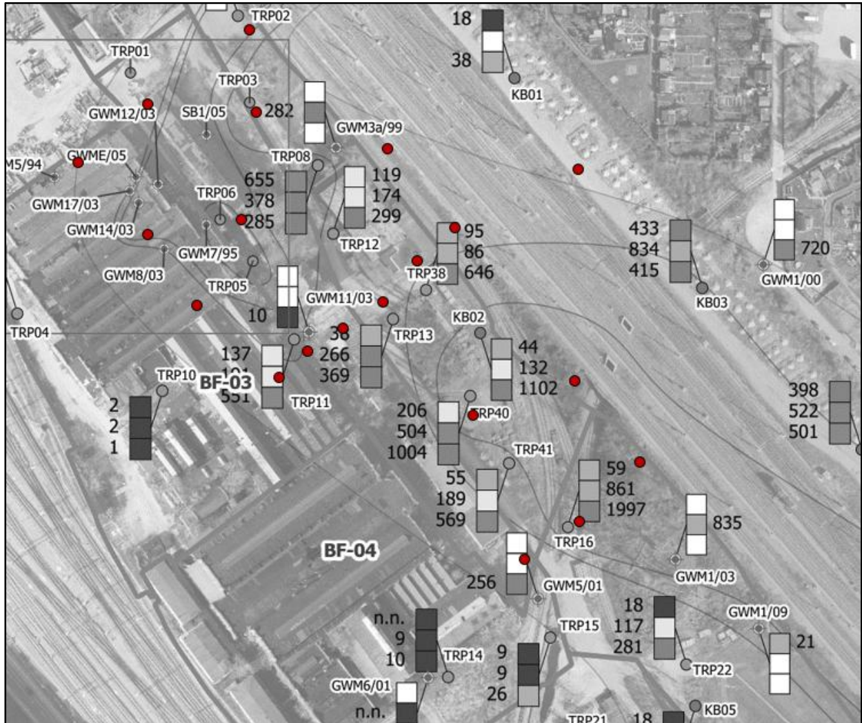
Abb. 9-2 vorgeschlagene Ansatzpunkte für die Kernbohrungen der Planungsphase 1 (5 KB als Reserve)
