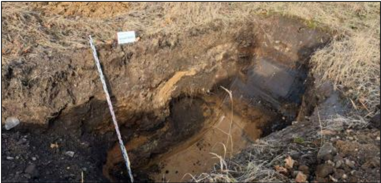
Abb. 7-6 Auffüllung (braun, ocker, graubraun bis 2,0 m, darunter Geschiebemergel (braun) im Schurf S-30/23 im BF08
