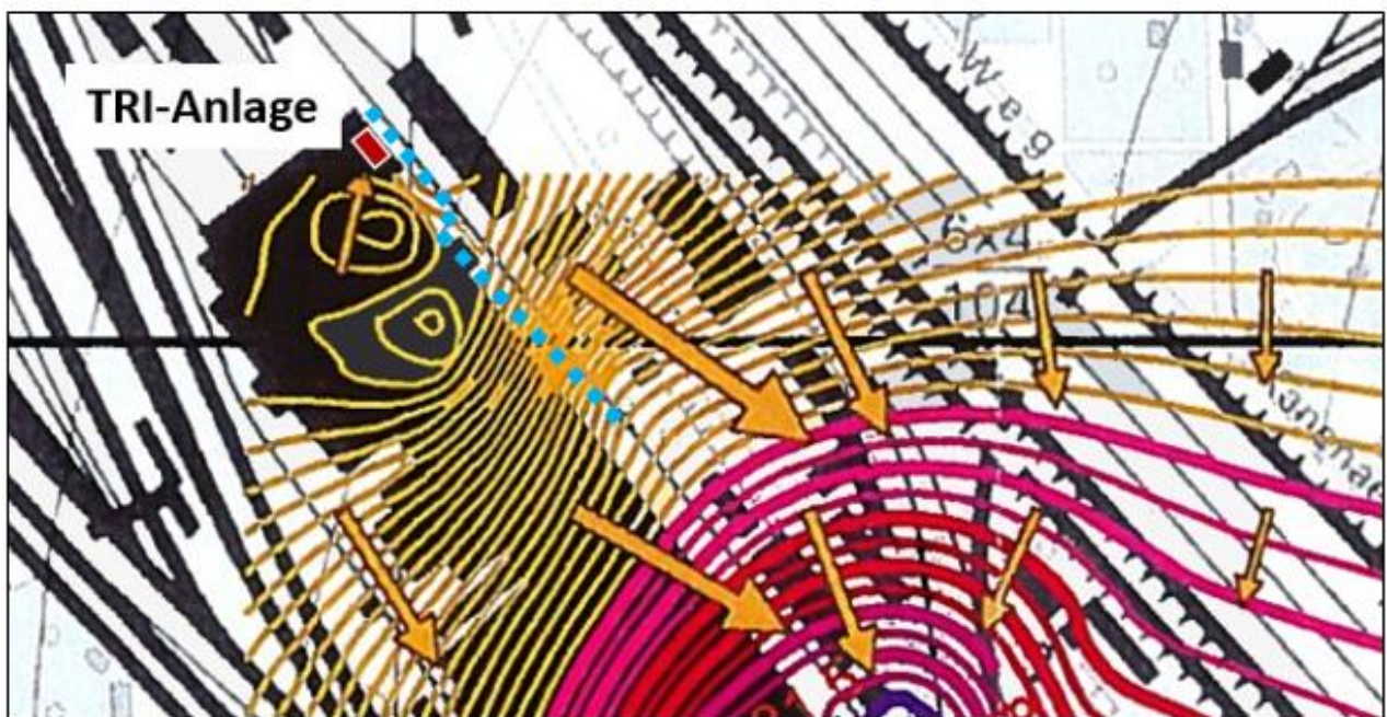
Abb. 6-20 Morphologie der Basis des GWL 15 im Umfeld der ehem. TRI-Anlage [U28]
