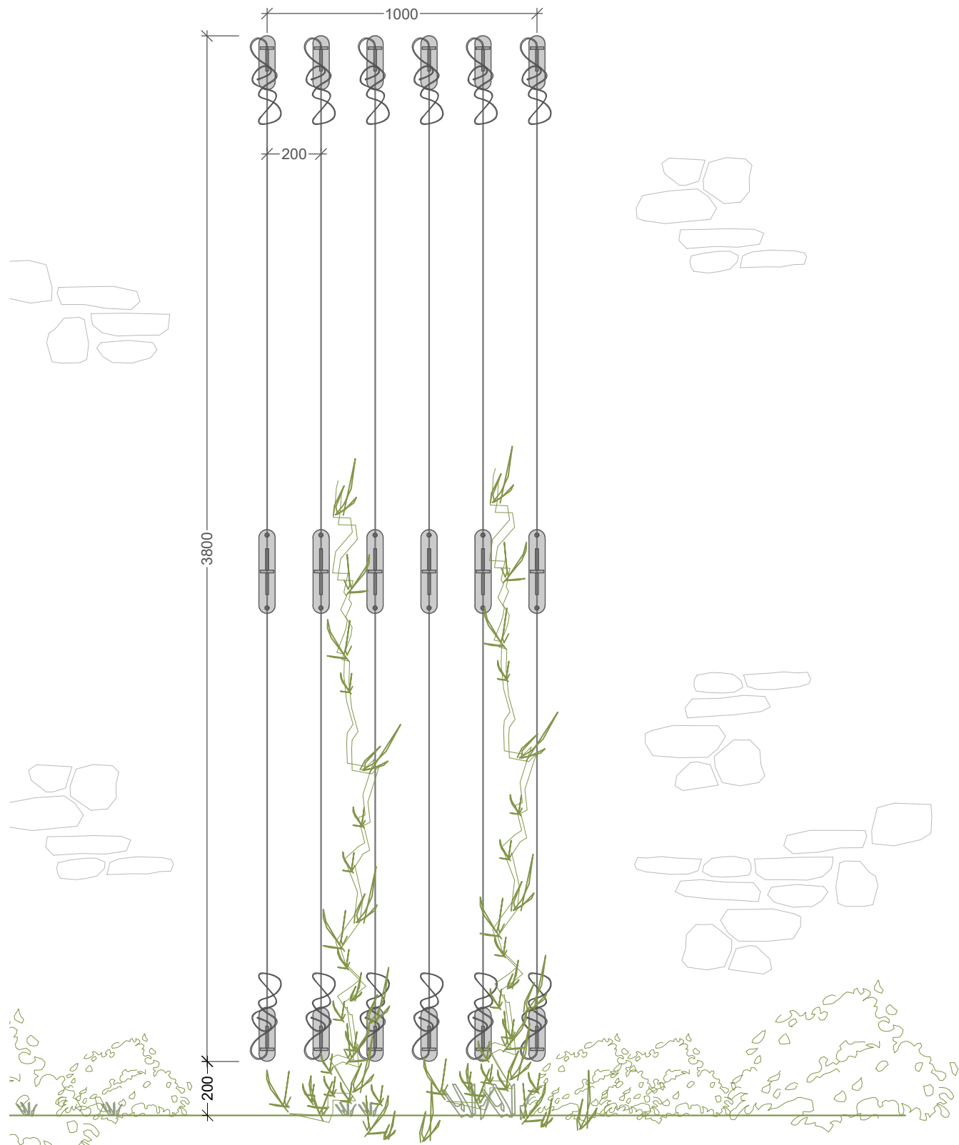
Vorderansicht Rankelemente, Maßstab 1:20
