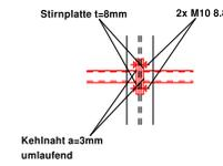
Detail b - Kippsicherung und Deckensicherung
