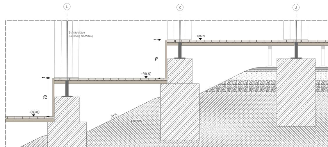
Schnitt 3: Abstufung Holzterrasse Hanglage West - im Bereich Schrägstützen
