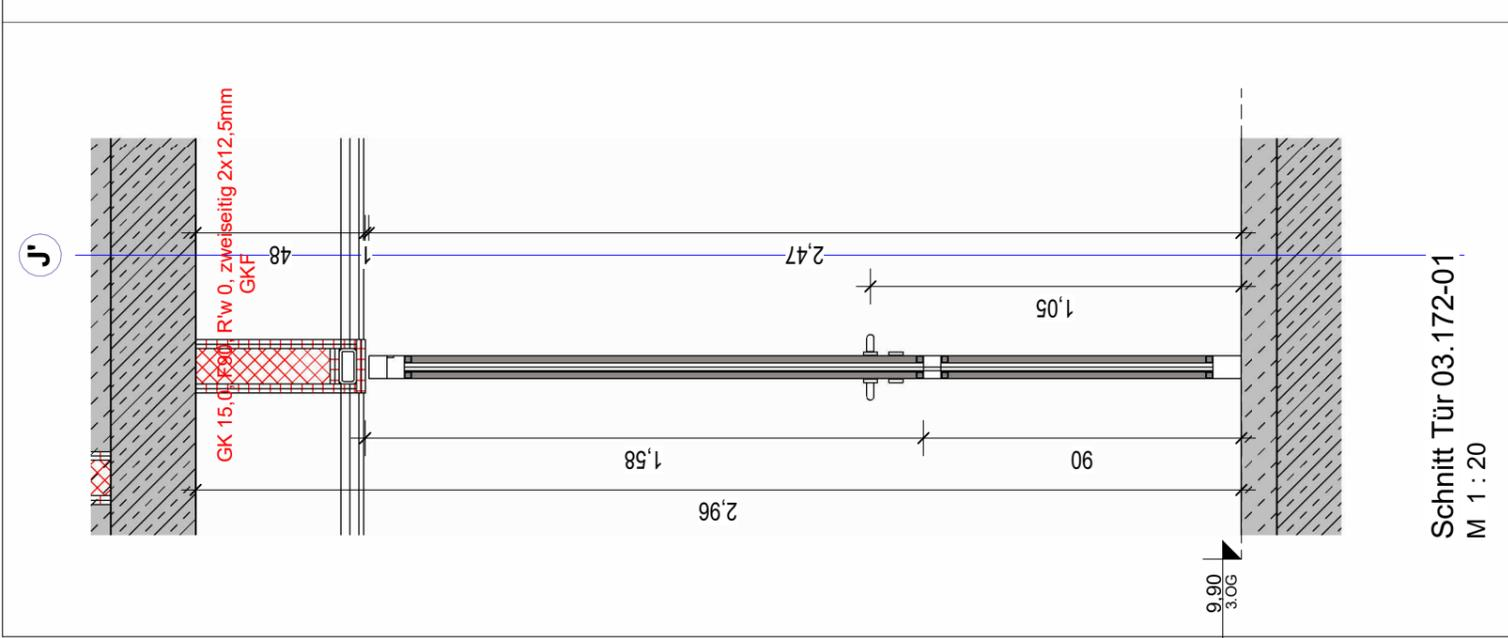
**Pos.05 - Metallbautür T30/RS im Umbau Bestand**
