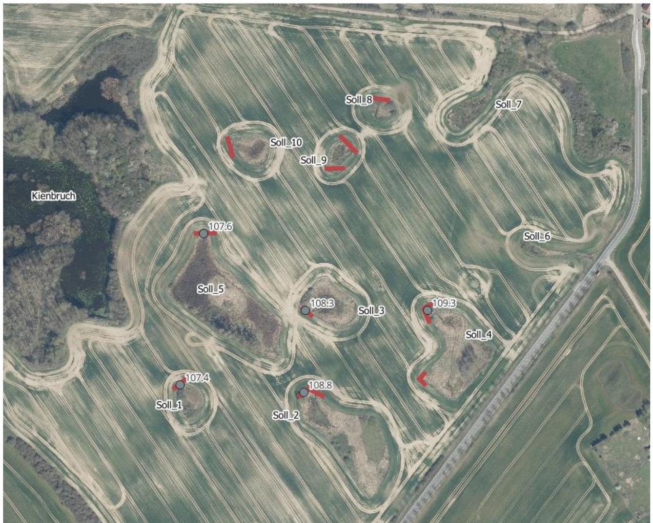
Abbildung 6 Bereich geplante Suchschachtungen (roter Balken) sowie Neubau von Schächten
