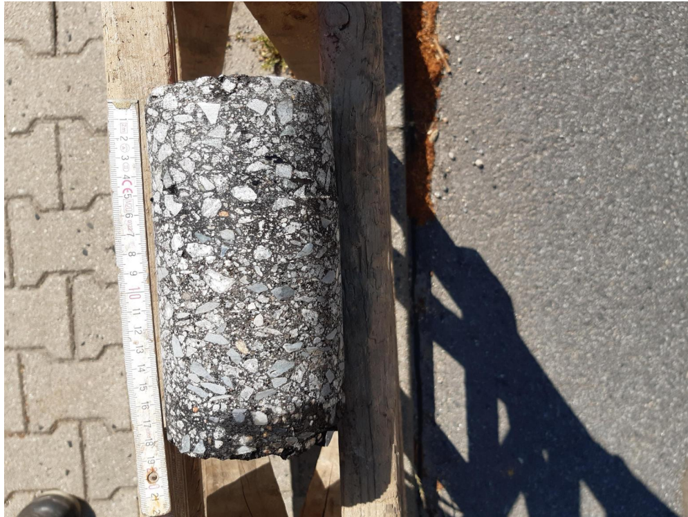
Foto 1: Asphaltbohrkern aus BP 01: 0,00 - 0,18 m (4-5 Schichten)
