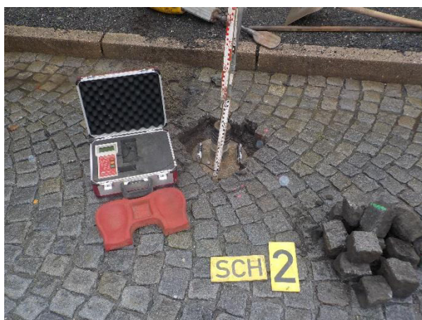
Abb. 5: HS 2, Fallplatte auf OK Tragschicht
