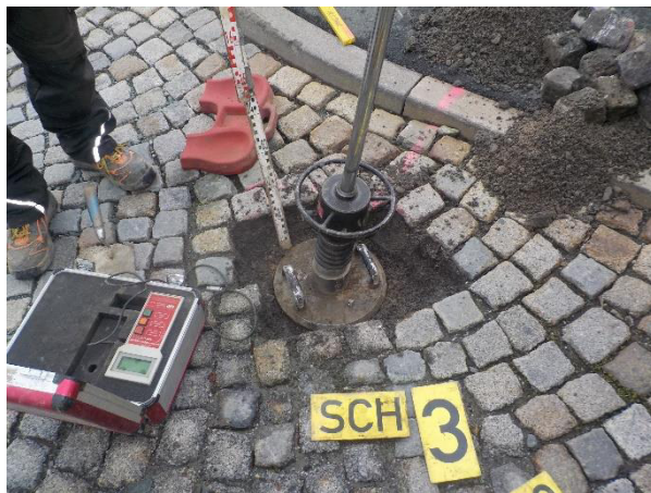
Abb. 11: HS 3, Fallplatte auf OK Tragschicht
