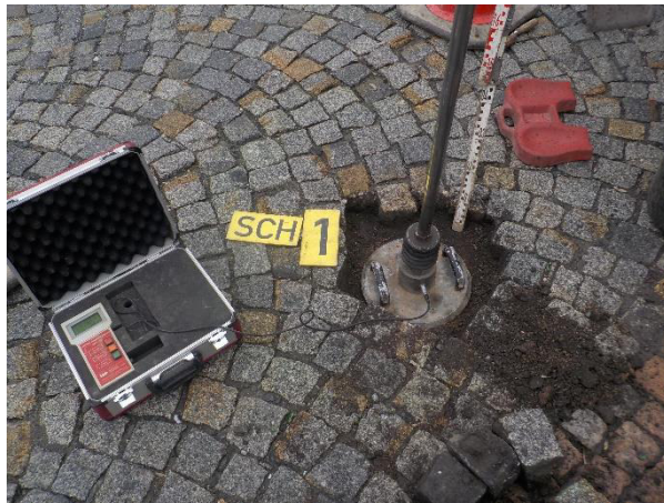
Abb. 1: HS 1, Fallplatte auf OK Tragschicht
