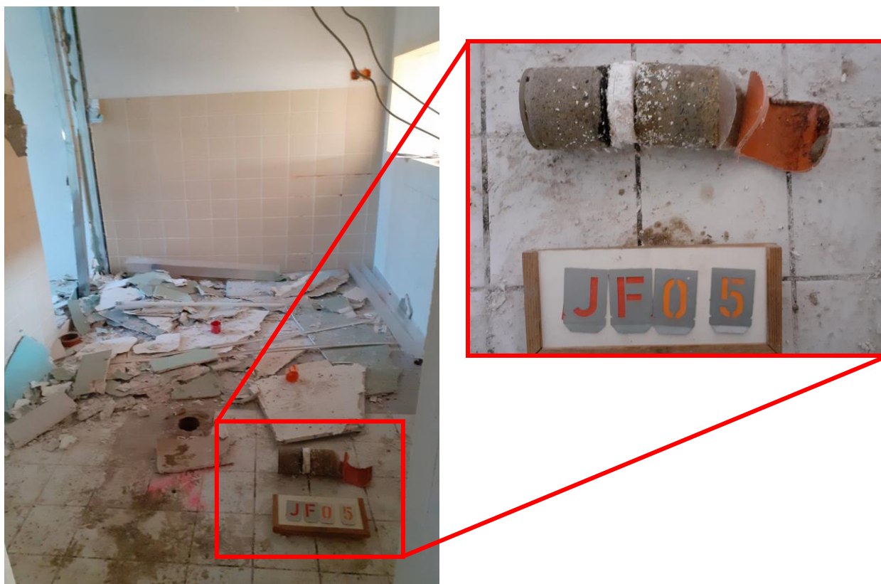
Abbildung 6.2.4: Fußbodenaufbau Jugendclub, Sanitärbereich
