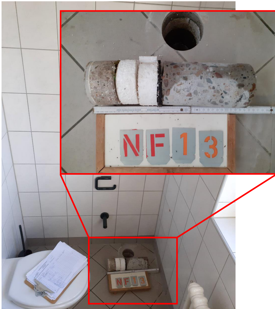
Abbildung 6.4.4: Aufbau Fußboden Schulungshaus, Sanitärbereich
