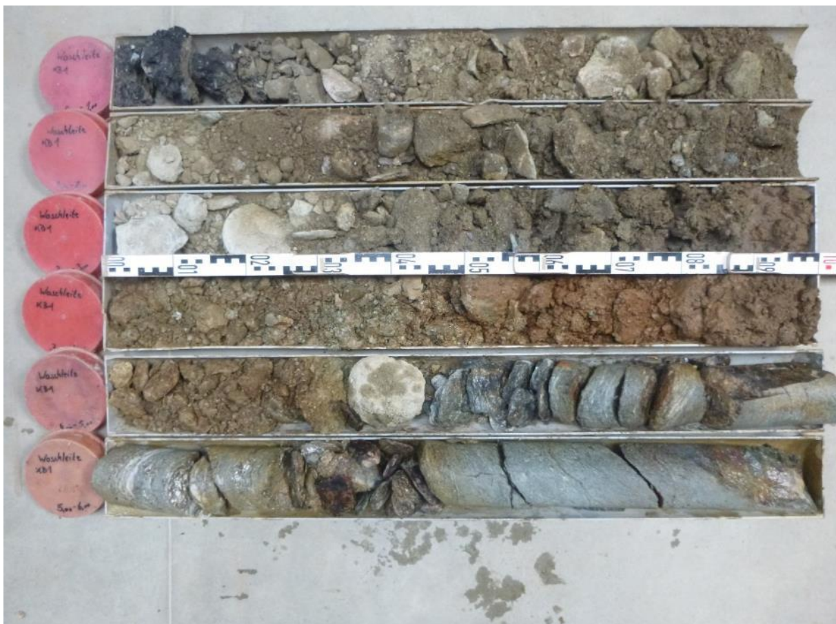
Ansicht Bohrkern der Rotationskernbohrung (KB) Nr. 1 (0,0 – 6,0 m)
