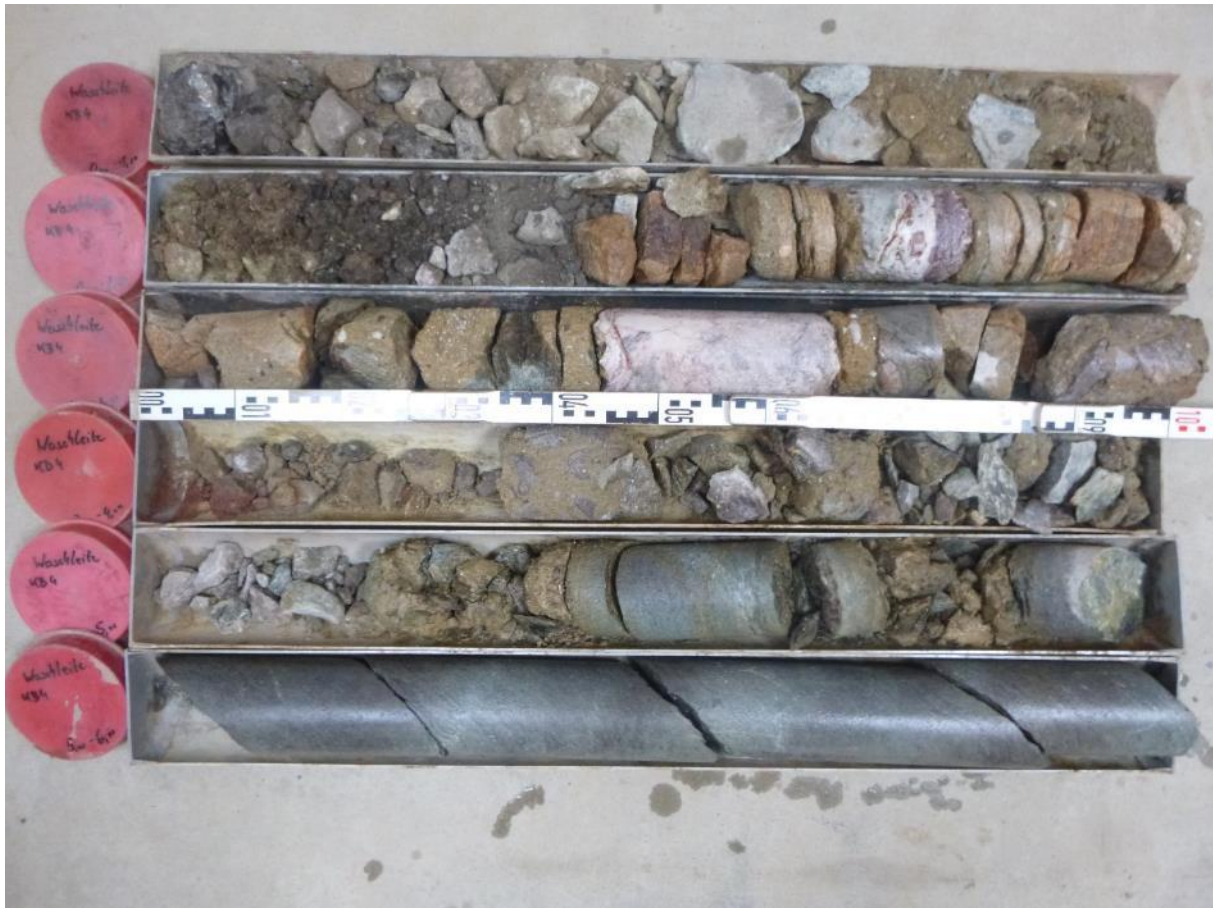
Ansicht Bohrkern der Rotationskernbohrung (KB) Nr. 4 (0,0 – 6,0 m)
