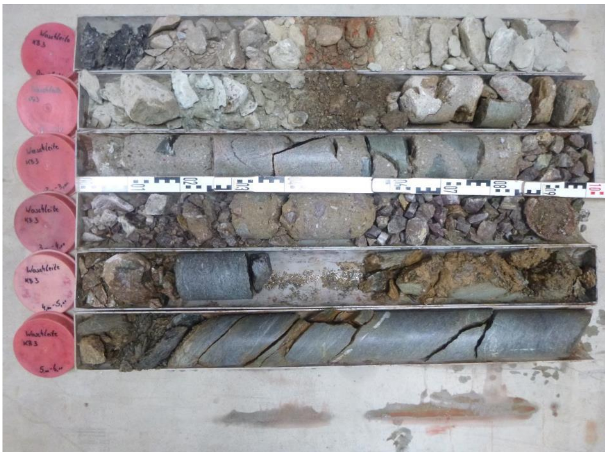
Ansicht Bohrkern der Rotationskernbohrung (KB) Nr. 3 (0,0 – 6,0 m)
