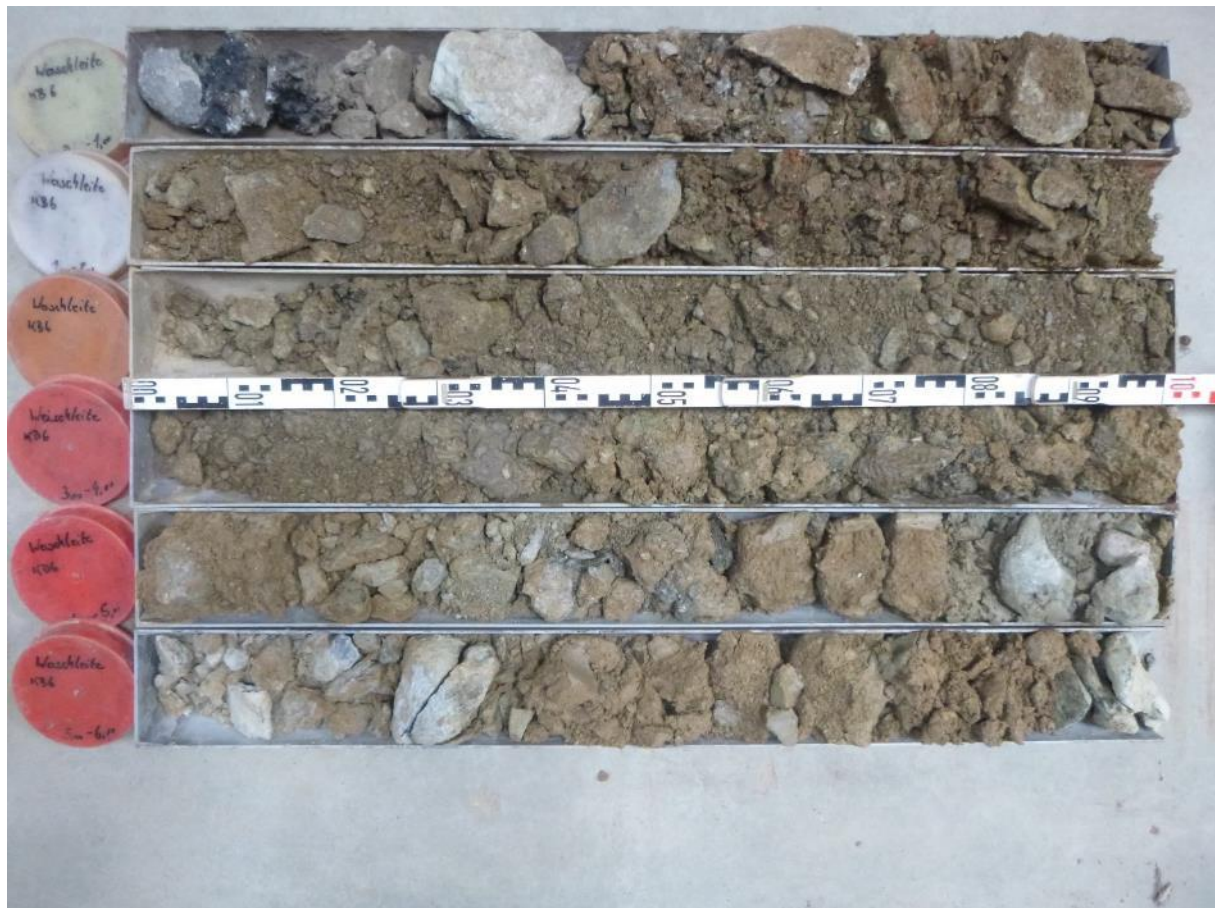
Ansicht Bohrkern der Rotationskernbohrung (KB) Nr. 6 (0,0 – 6,0 m)
