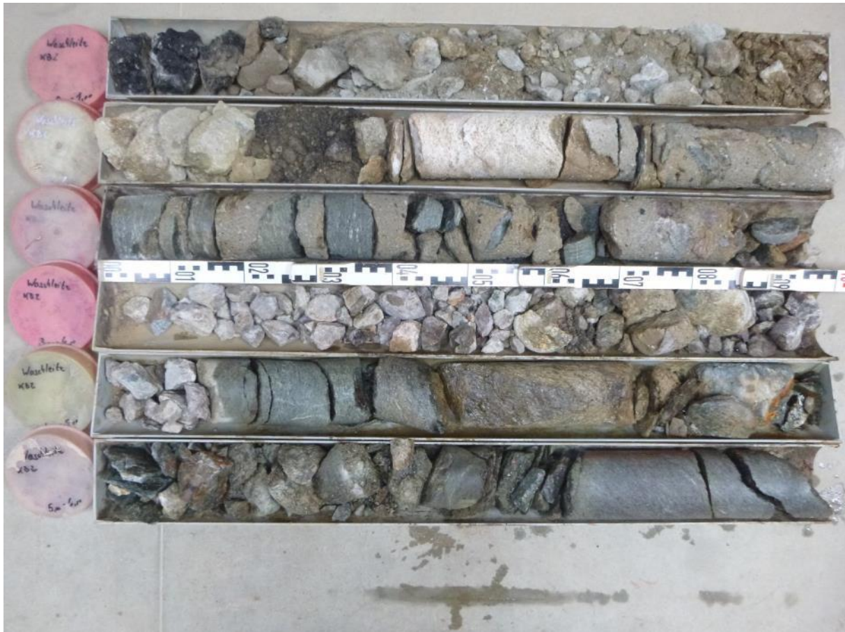
Ansicht Bohrkern der Rotationskernbohrung (KB) Nr. 2 (0,0 – 6,0 m)
