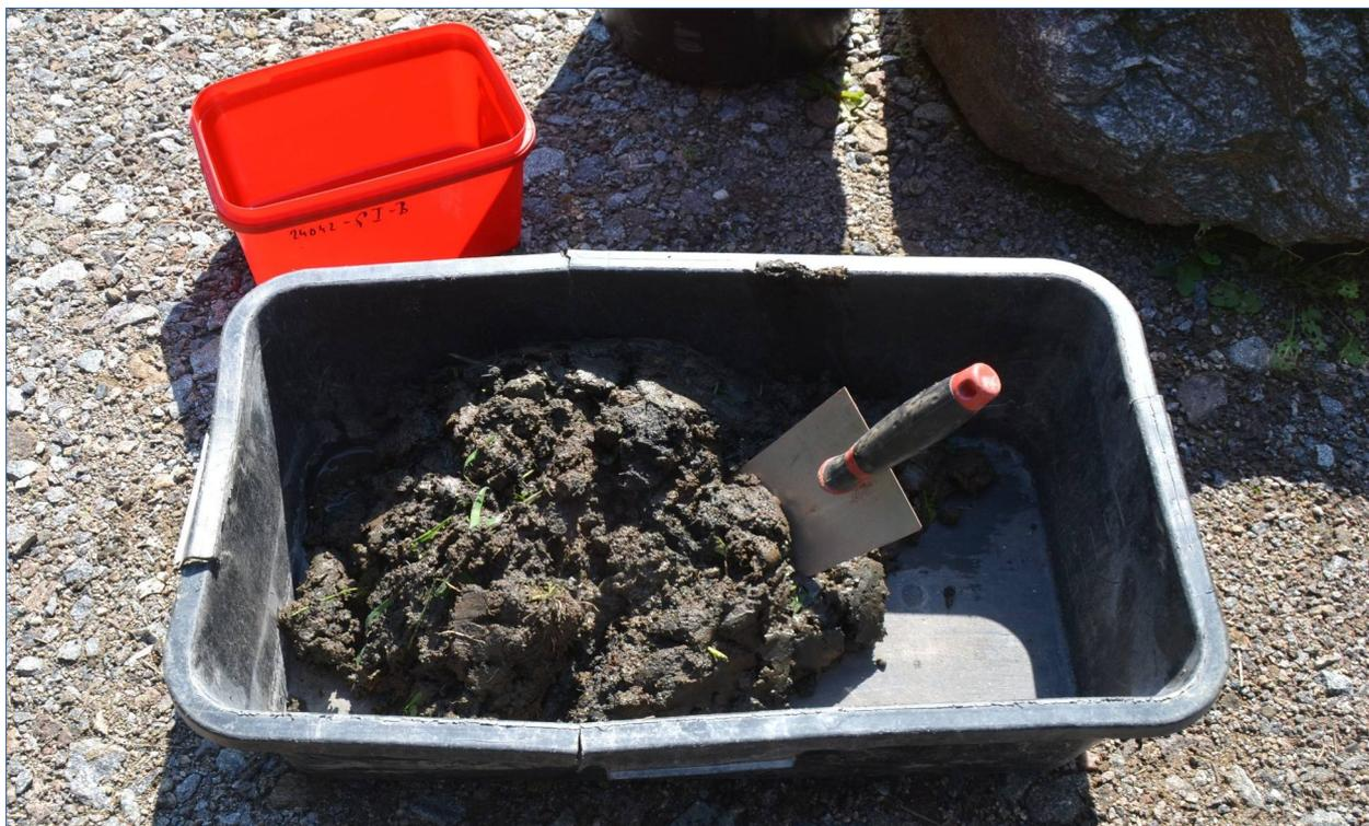
Entnahme einer EP bis ca. 60 cm Sedimentstärke, Sektor S-III, stark feucht
