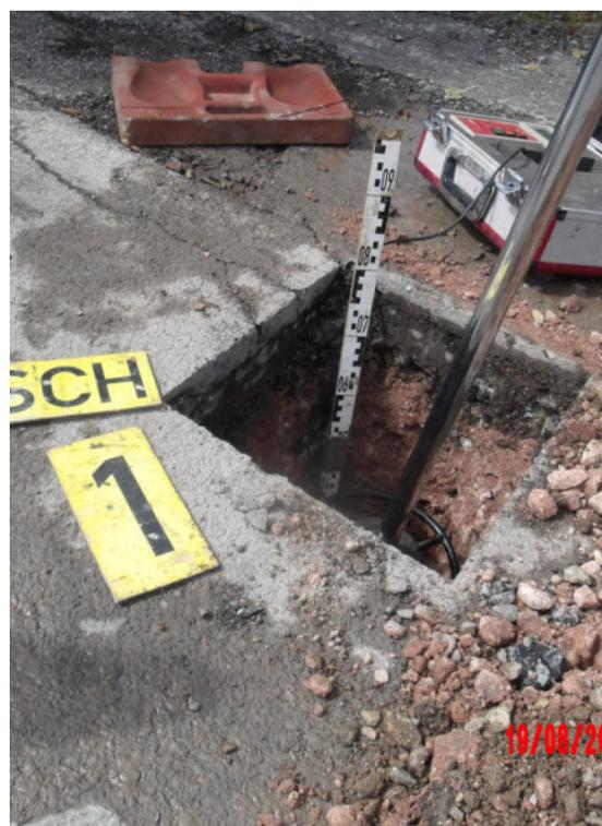
Abb. 4: Detailaufnahme – HS 1 mit Fallplatte auf Planum
