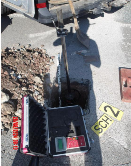
Abb. 9: Detailaufnahme – HS 2 mit Fallplatte auf Planum
