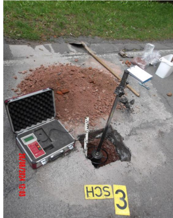
Abb. 14: Detailaufnahme – HS 3 mit Fallplatte auf Planum
