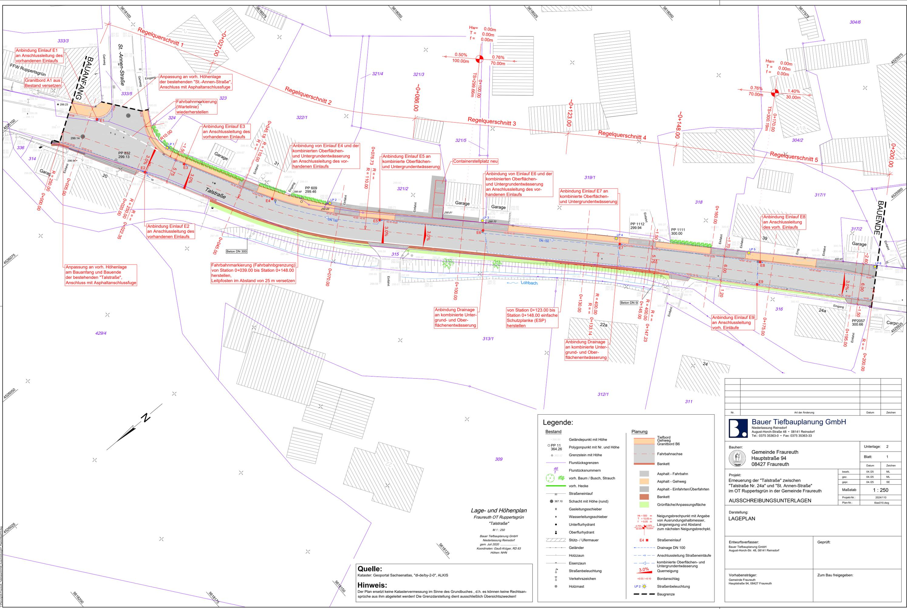
Anpassung an vorh. Höhenlage am Bauanfang und Bauende der bestehenden "Talstraße", Anschluss mit Asphaltanschlussfuge
