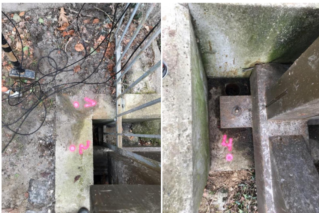
Abb. 2: Anregungspunkte für die Parallelseismik-Messung. Für beide Brückenwiderlager wurden die Anregungspunkte 1 (GOK) und 4 (GOK-0,71) verwendet.
