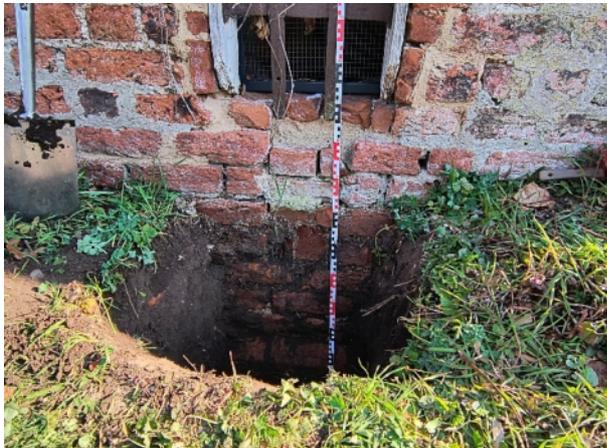
**Abb. 3** Schurf mit Endteufe von 1,40 m.
