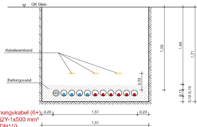
6x Gleichspannungskabel (6+)
