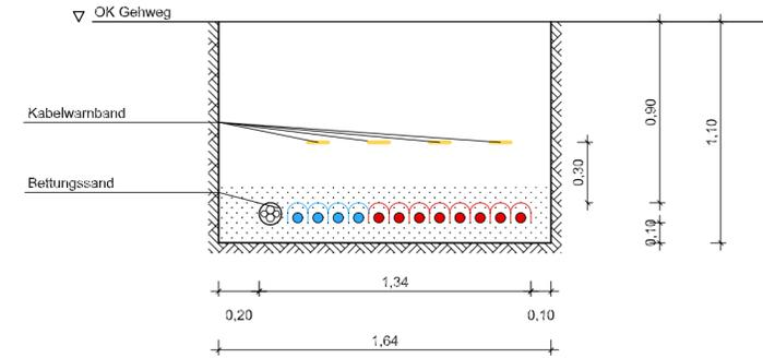
8x Gleichspannungskabel (8+)
