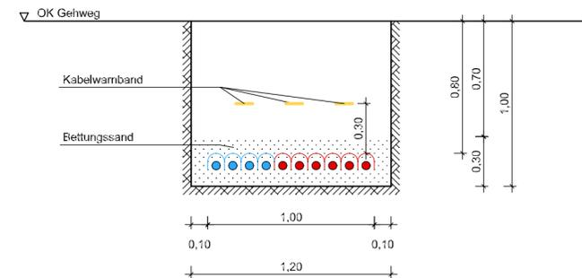
6x Gleichspannungskabel (6+)
