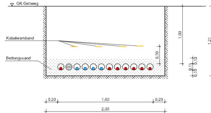
7x Gleichspannungskabel (6+)
