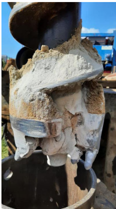
Foto Nr. 34: KB 14/22 Bohrmateriale aus 7,60 m Tiefe bei Bohrabbruch
