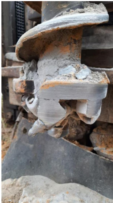
Foto Nr. 32: KB 13/22 verschlissenes Bohrwerkzeug aufgrund Bohrhindernis
