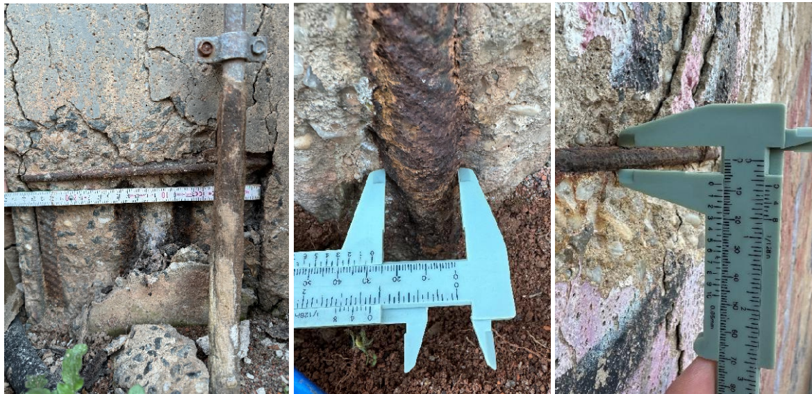
Abbildung 4: Bewehrungsdurchmesser Längsbewehrung (links/mitte) und Bügel (rechts)
